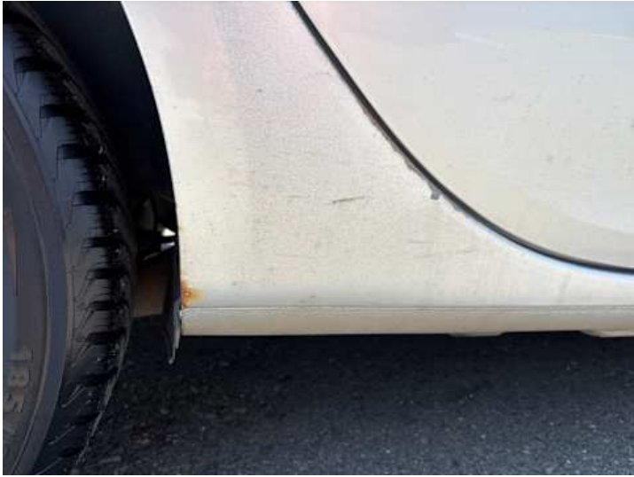
Schweller rechts (Rost)
