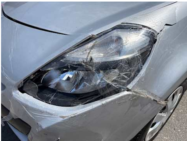
Scheinwerfer (links) (Riss/Bruch)
