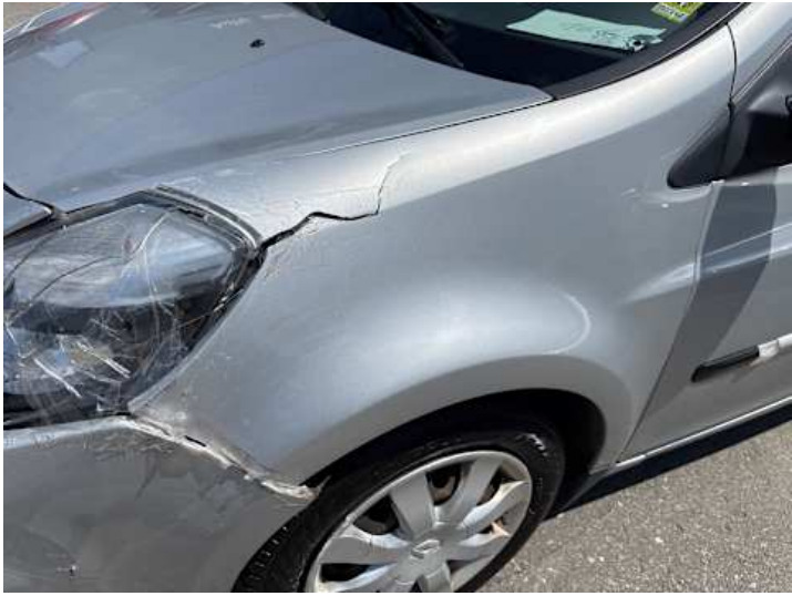
Kotflügel vorne links (Riss/Bruch)
