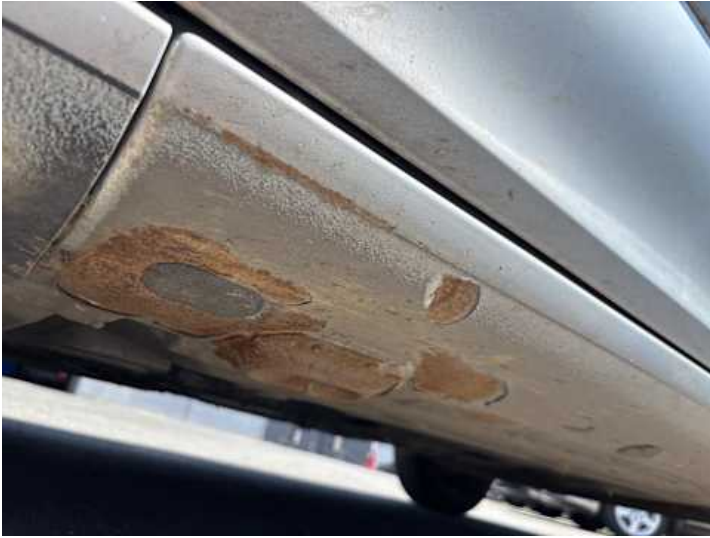
Schweller links (Rost)
