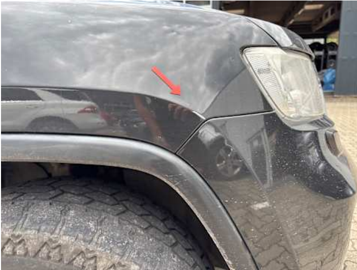
Kotflügel vorne rechts (Kratzer, Lackschaden)
