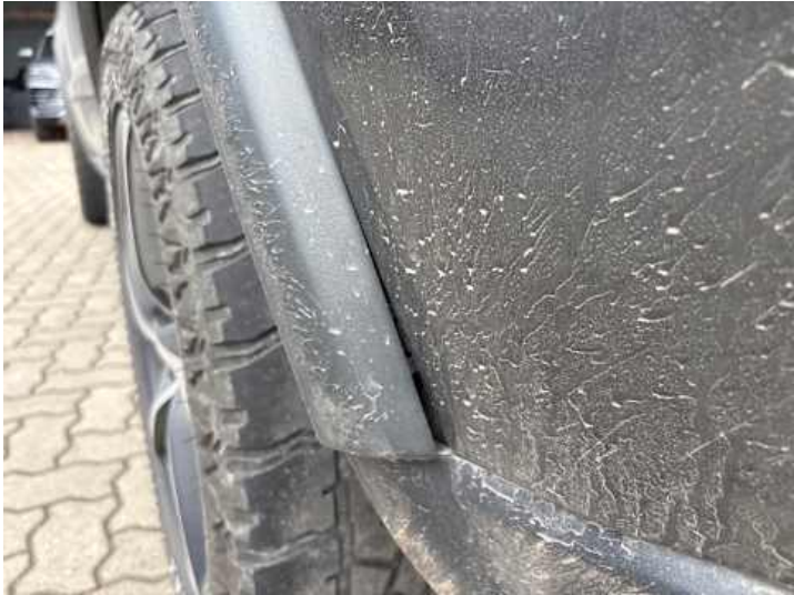
Seitenteil hinten links (Riss/Bruch)
