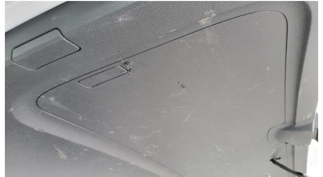
Heckklappenverkleidung zerkratzt ern.
