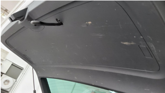
Heckklappenverkleidung zerkratzt ern.
