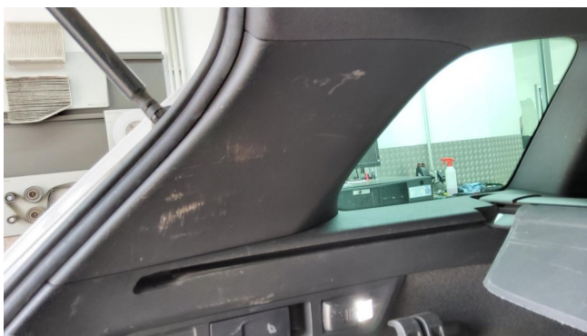
D - Säulenverkleidungen li. re. zerkratzt ern
