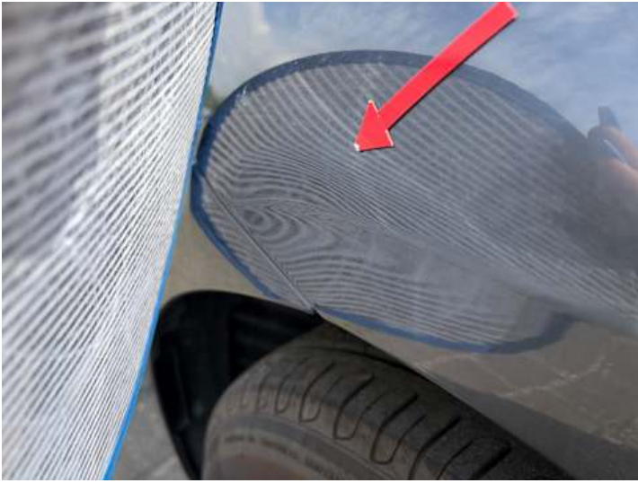
Kotflügel vorne links (Verformung)
