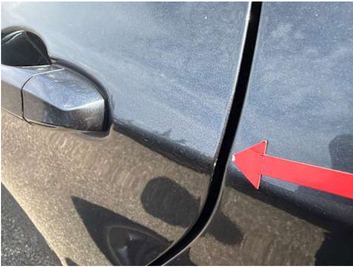
Türe hinten links (Lackschaden)
