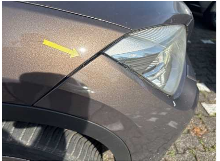
Stoßstange vorne (Spaltmaße ungenau)
