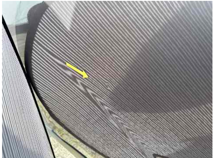
Türe hinten rechts (Delle)
