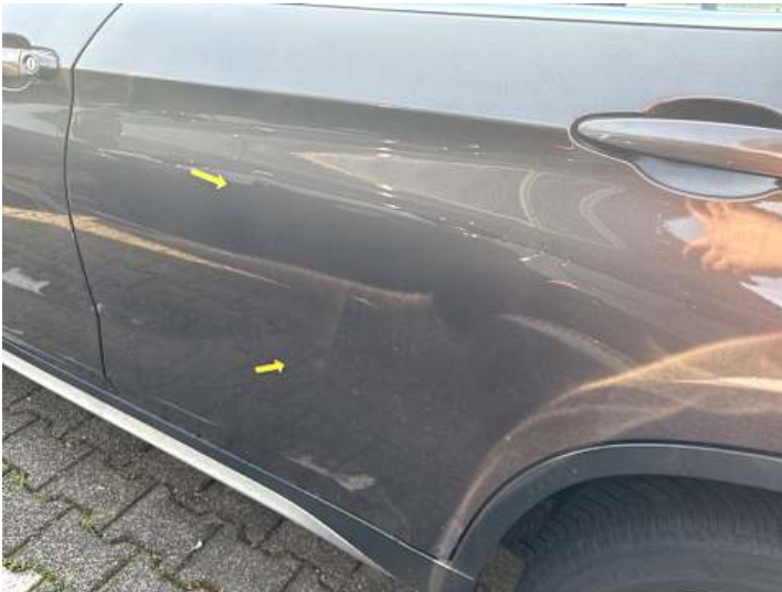
Türe hinten links (Delle)
