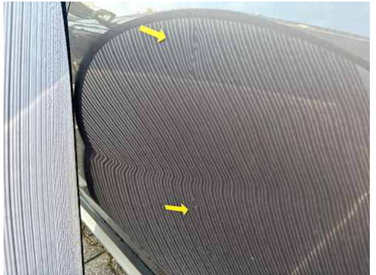
Türe hinten links (Delle)
