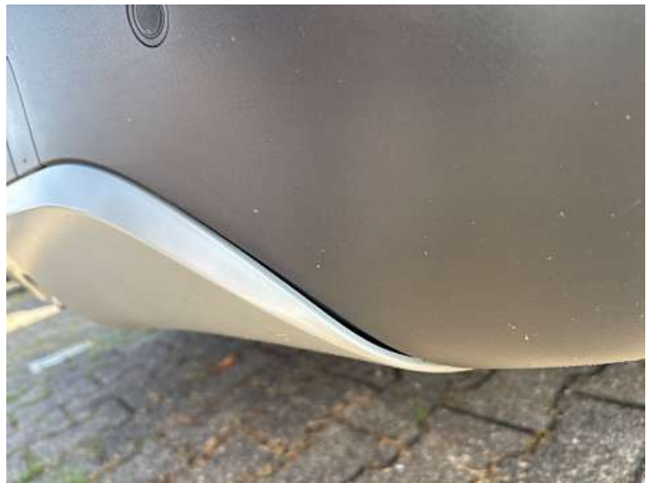
Stoßstange hinten (Spaltmaße ungenau)
