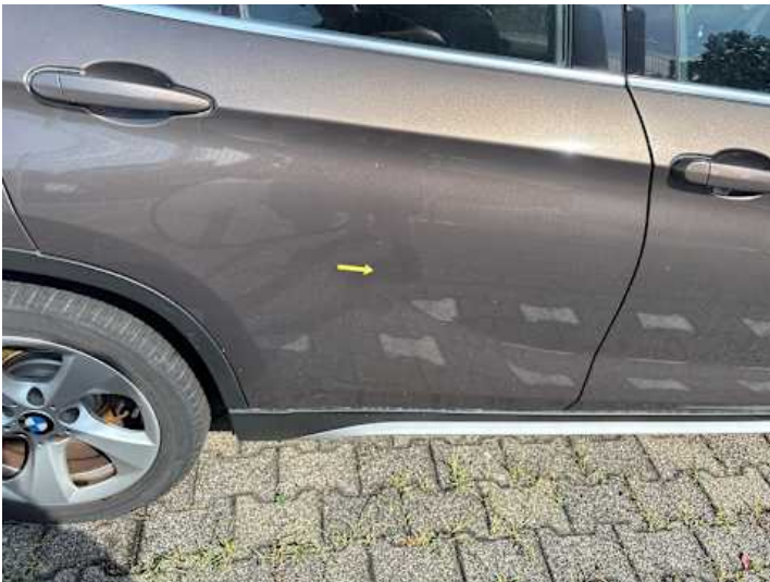
Türe hinten rechts (Delle)
