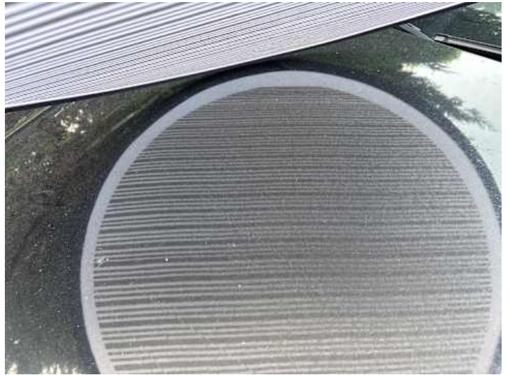
Motorhaube (Unsachgemäß instand gesetzt)
