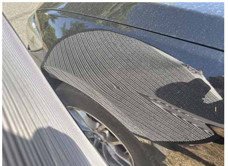
Kotflügel vorne links (Verformung)
