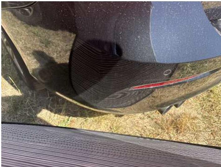
Stoßstange hinten (Verformung)
