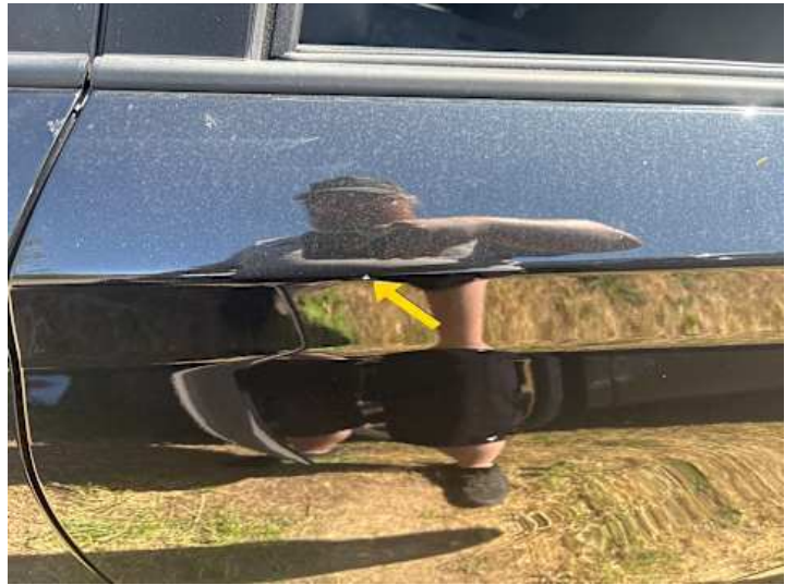
Türe hinten links (Kratzer)
