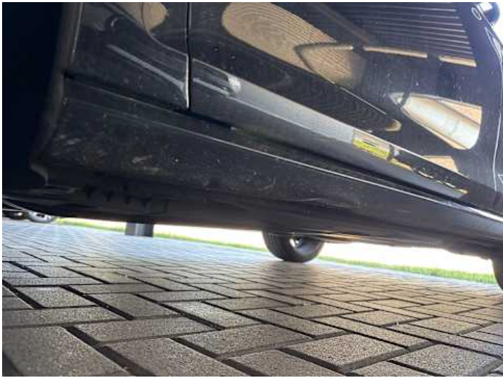
Schweller links (Kratzer, Delle)
