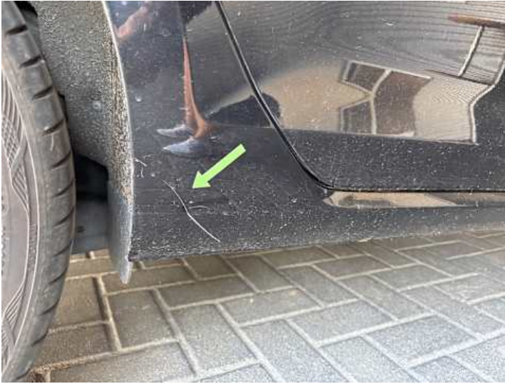
Schweller rechts (Kratzer)
