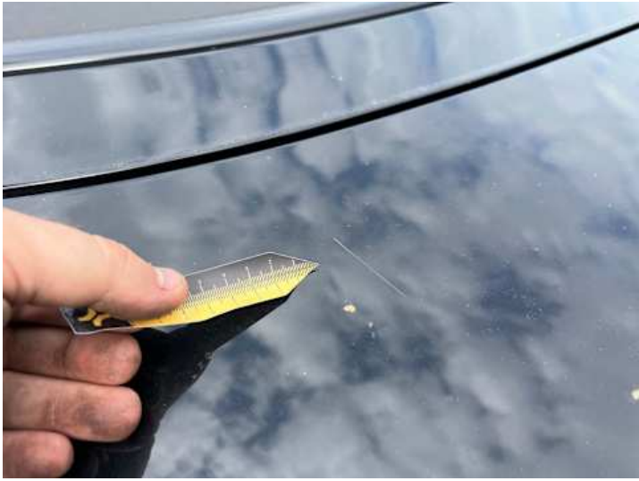
Heckklappe (Kratzer, Lackschaden)
