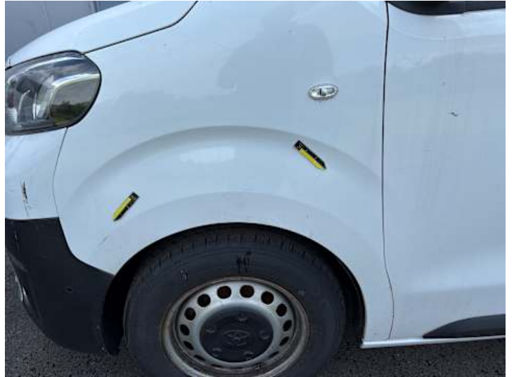
Kotflügel vorne links (Verformung, Lackschaden)
