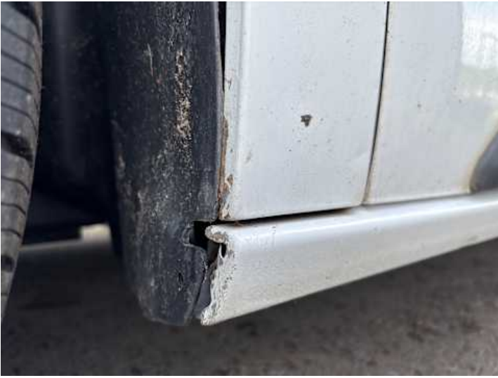
Kotflügel vorne links (Rost)
