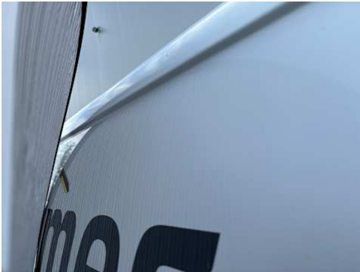
Seitenteil hinten links (Lackschaden, Verformung, Delle)
