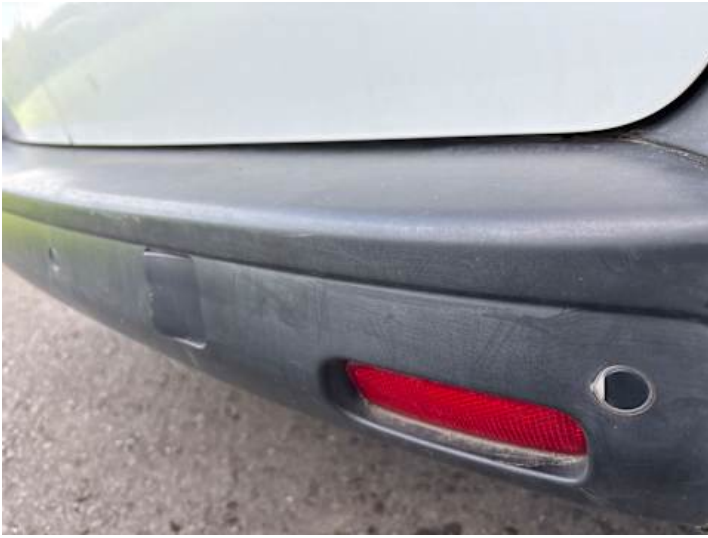
Stoßstange hinten (Lackschaden, Verformung)
