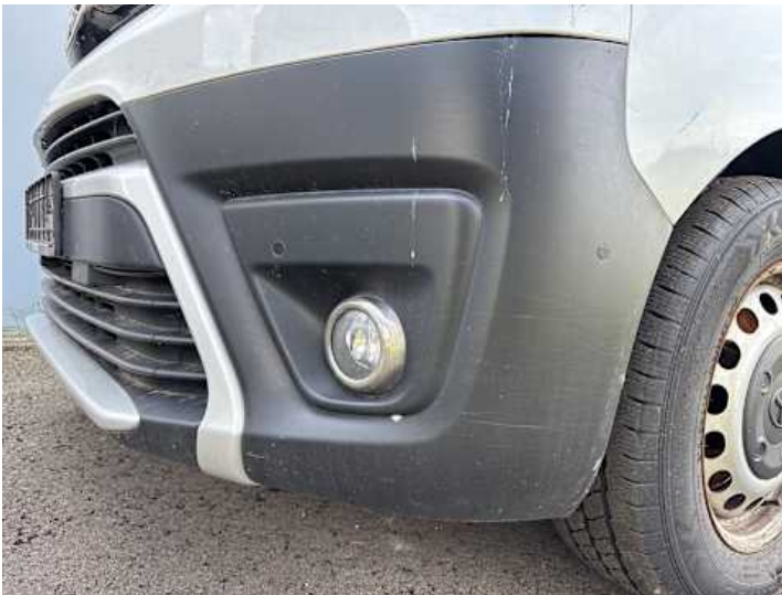
Stoßstange vorne (Lackschaden)
