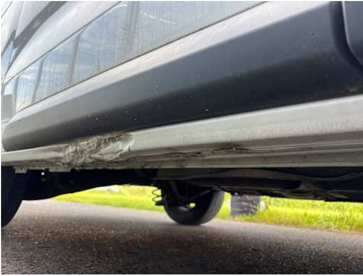
Schweller rechts (Lackschaden, Verformung, Riss/Bruch)
