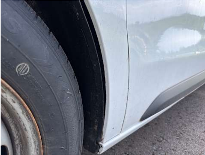
Kotflügel vorne links (Verformung, Lackschaden)
