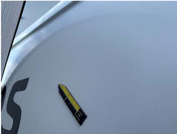
Seitenteil hinten links (Lackschaden, Verformung, Delle)
