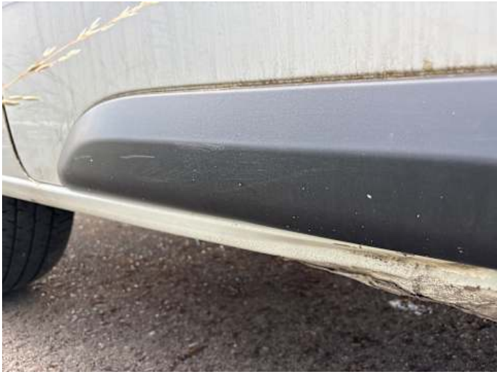
Türe hinten rechts (Lackschaden)
