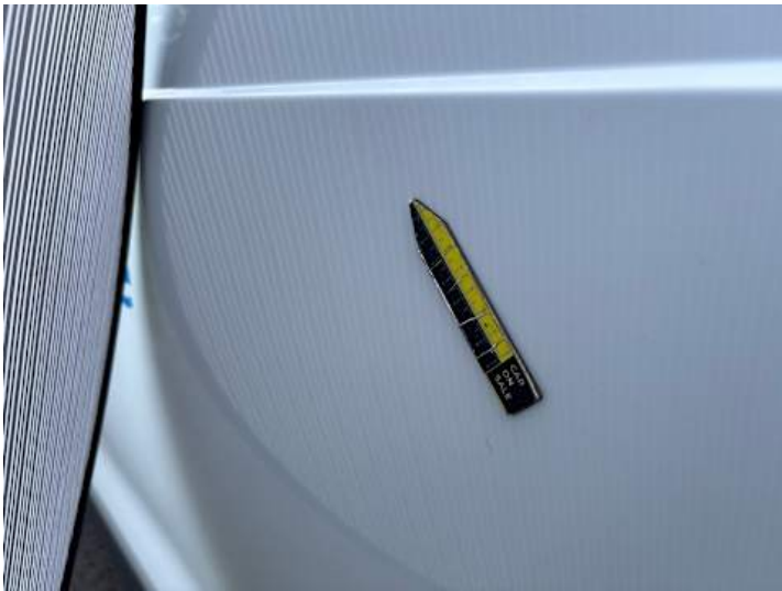
Seitenteil hinten links (Lackschaden, Verformung, Delle)
