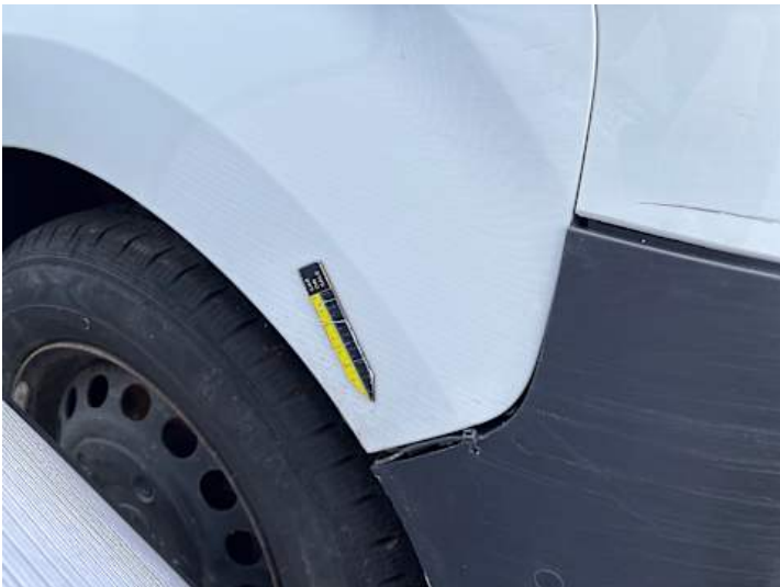
Kotflügel vorne rechts (Lackschaden, Verformung)
