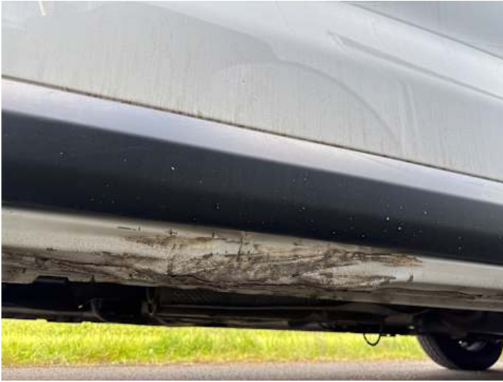
Schweller rechts (Lackschaden, Verformung, Riss/Bruch)
