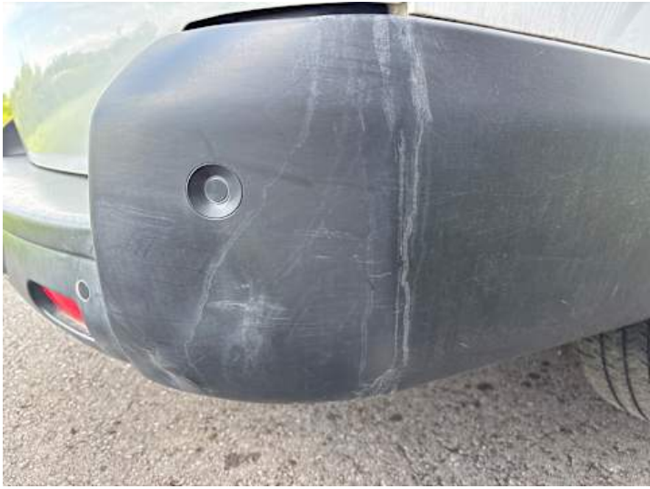
Stoßstange hinten (Lackschaden, Verformung)
