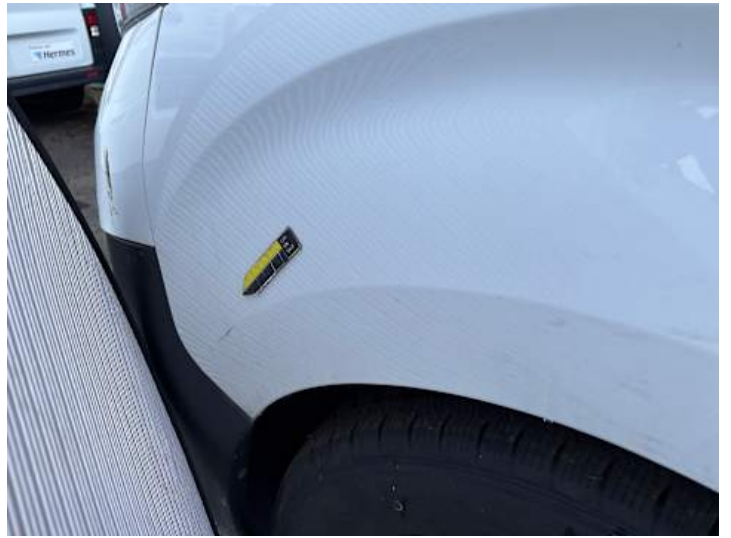
Kotflügel vorne links (Verformung, Lackschaden)
