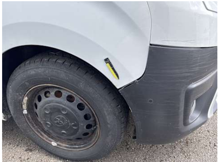
Kotflügel vorne rechts (Lackschaden, Verformung)
