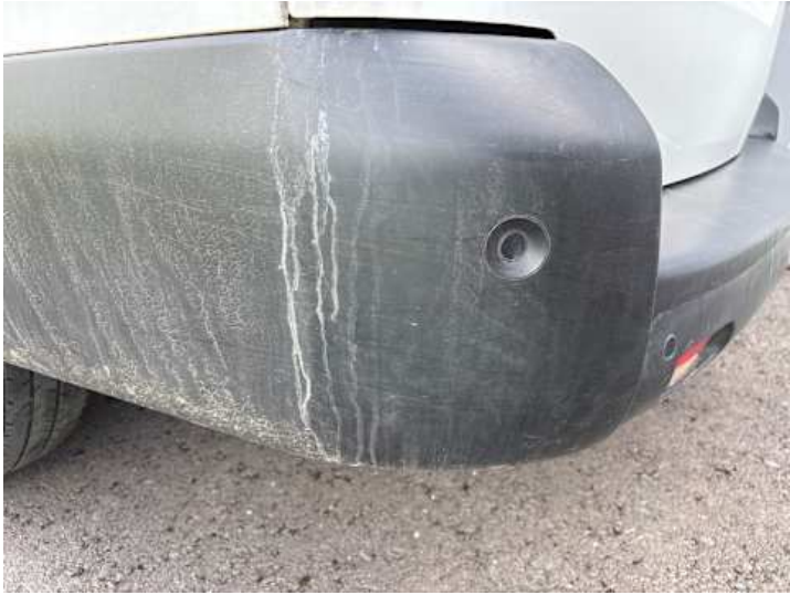
Stoßstange hinten (Lackschaden, Verformung)
