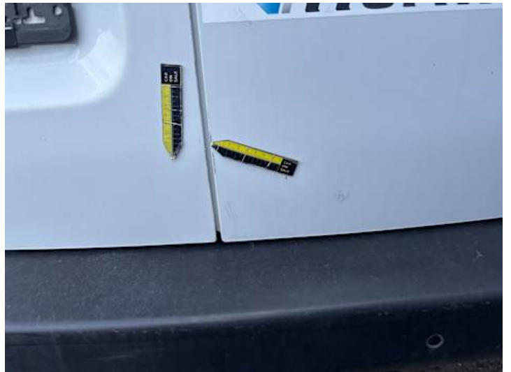
Heckklappe (Lackschaden, Verformung)
