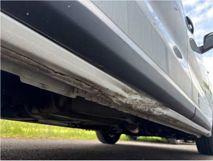
Schweller rechts (Lackschaden, Verformung, Riss/Bruch)
