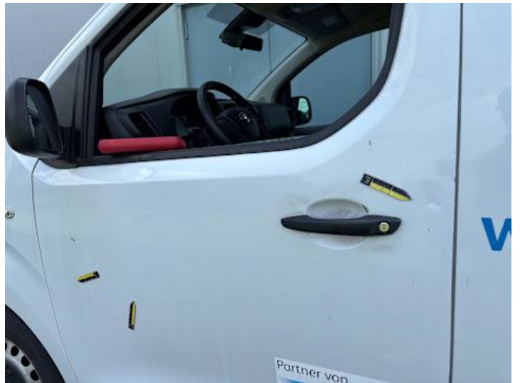
Fahrtür (Delle, Kratzer)
