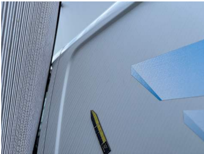
Seitenteil hinten links (Lackschaden, Verformung, Delle)
