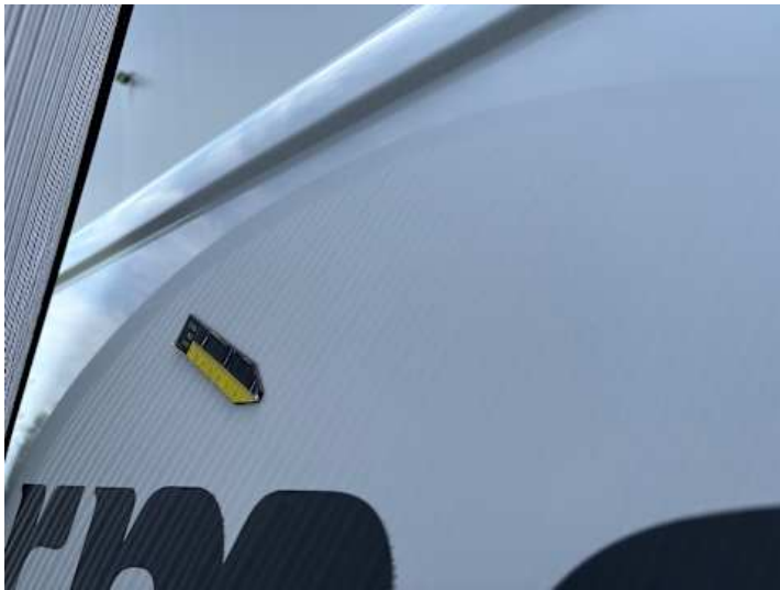
Seitenteil hinten links (Lackschaden, Verformung, Delle)
