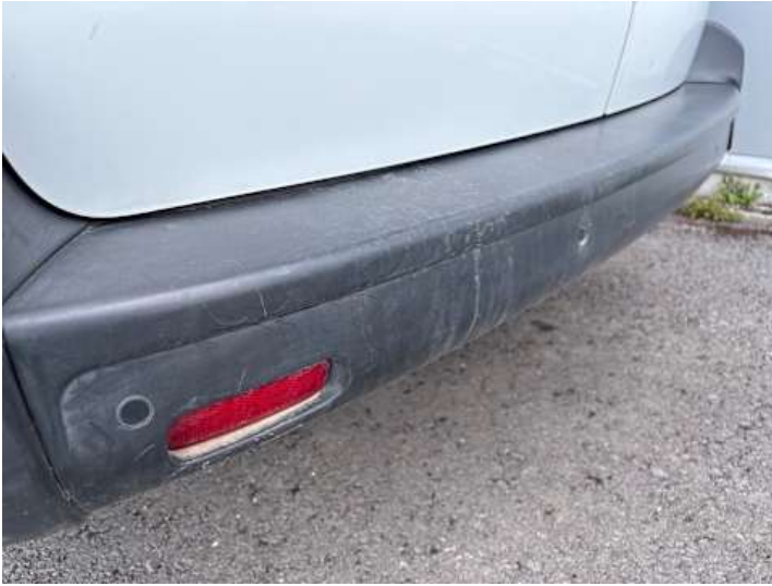
Stoßstange hinten (Lackschaden, Verformung)
