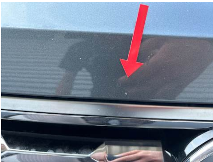
Motorhaube (Lackschaden, Steinschlag)
