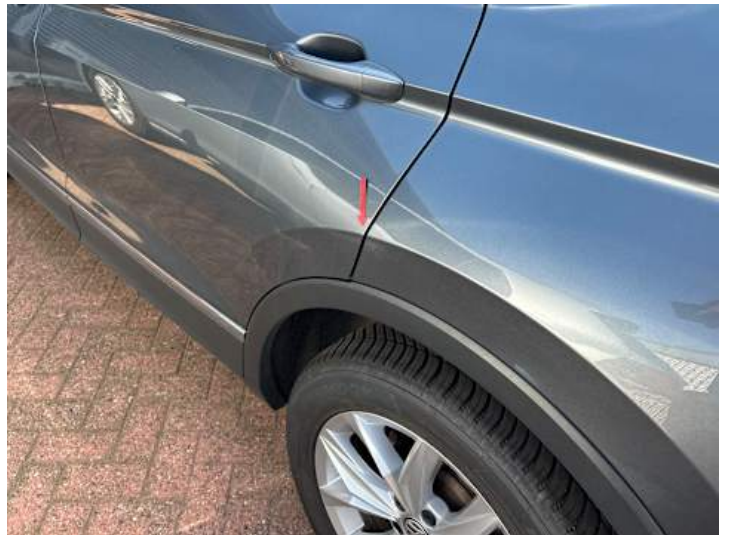
Türe hinten links (Lackschaden)
