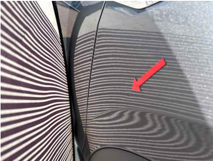
Kotflügel vorne rechts (Lackschaden, Delle)
