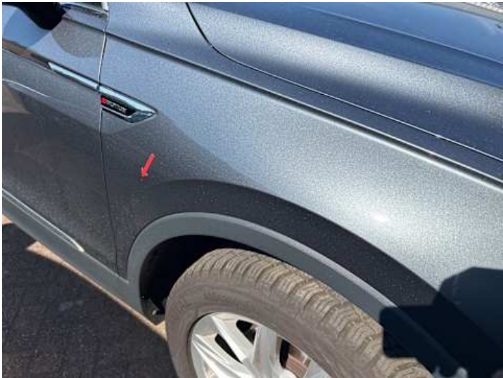
Kotflügel vorne rechts (Lackschaden, Delle)
