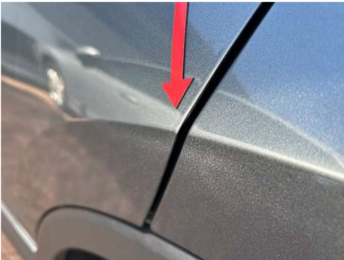
Türe hinten links (Lackschaden)
