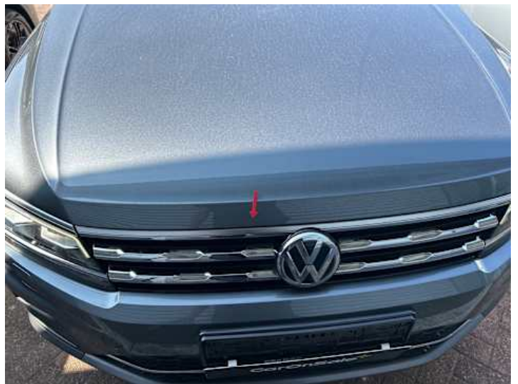
Motorhaube (Lackschaden, Steinschlag)
