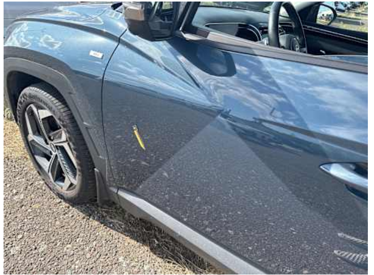
Fahrtür (Kratzer, Delle)
