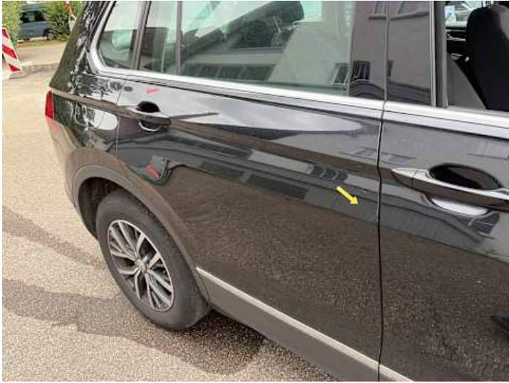
Türe hinten rechts (Kratzer)
