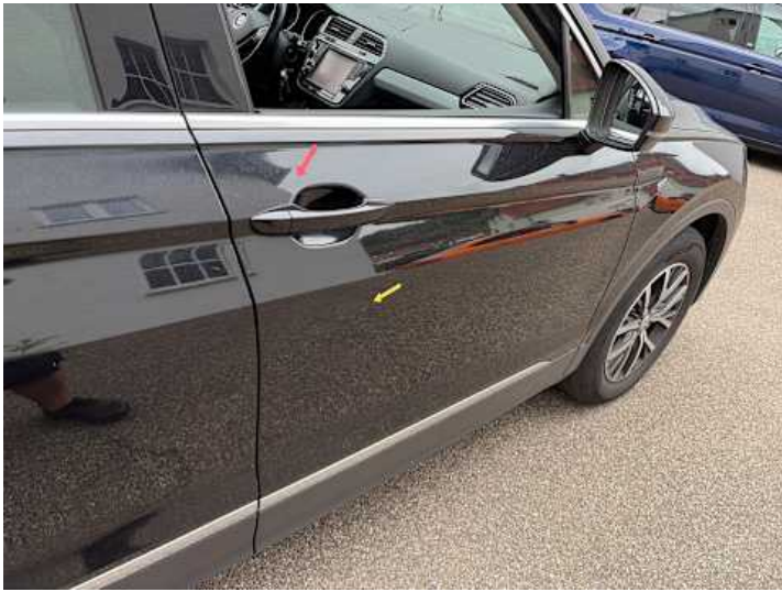
Beifahrertür (Kratzer, Delle)
