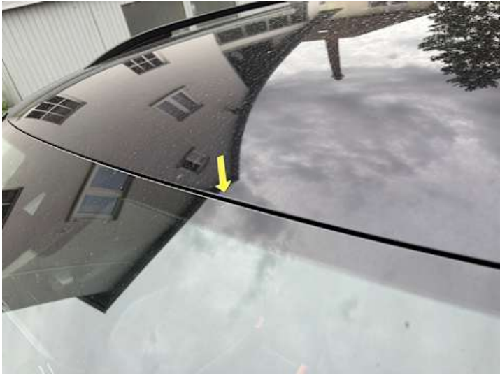
Dach (Steinschlag, Rost)
