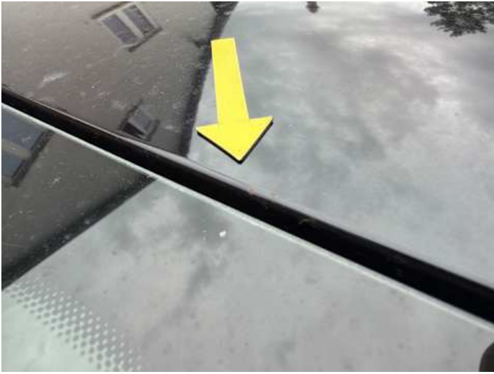
Dach (Steinschlag, Rost)
