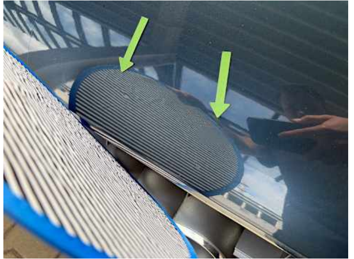
Motorhaube (Delle, Ausgeblichen/Matt)
