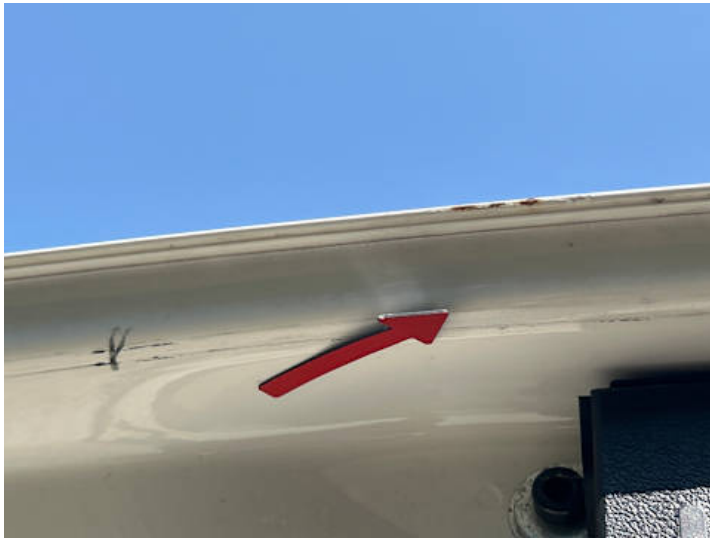
Heckklappe (Kratzer, Rost)
