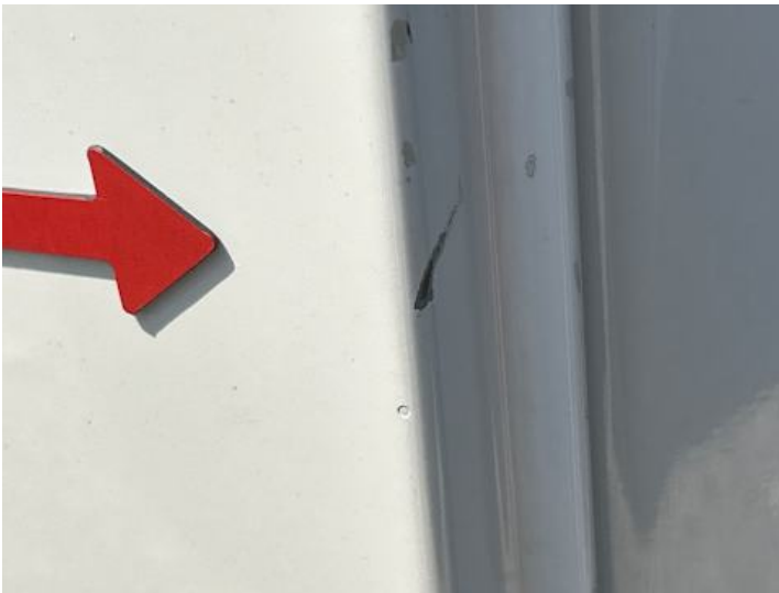
Türe hinten rechts (Kratzer)
