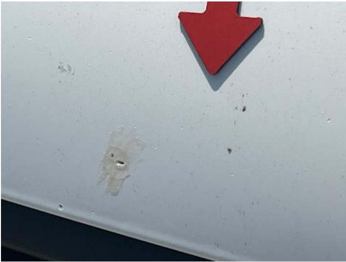
Motorhaube (Unsachgemäß instand gesetzt)
