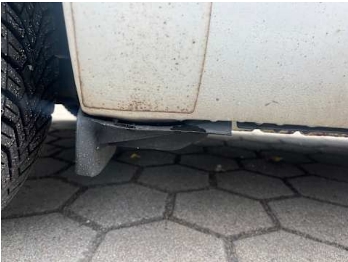
Schweller rechts (Riss/Bruch)
