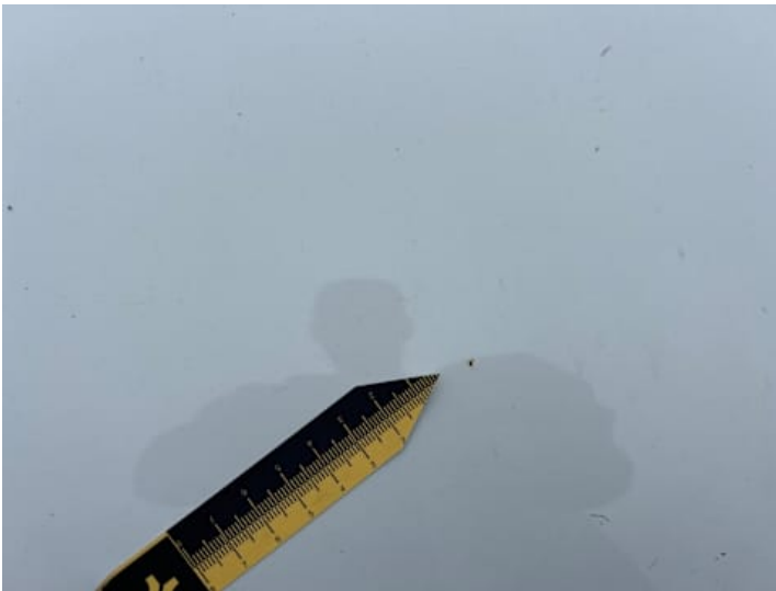
Motorhaube (Steinschlag, Rost)
