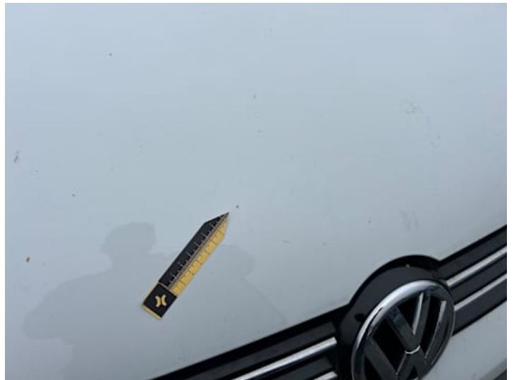
Motorhaube (Steinschlag, Rost)
