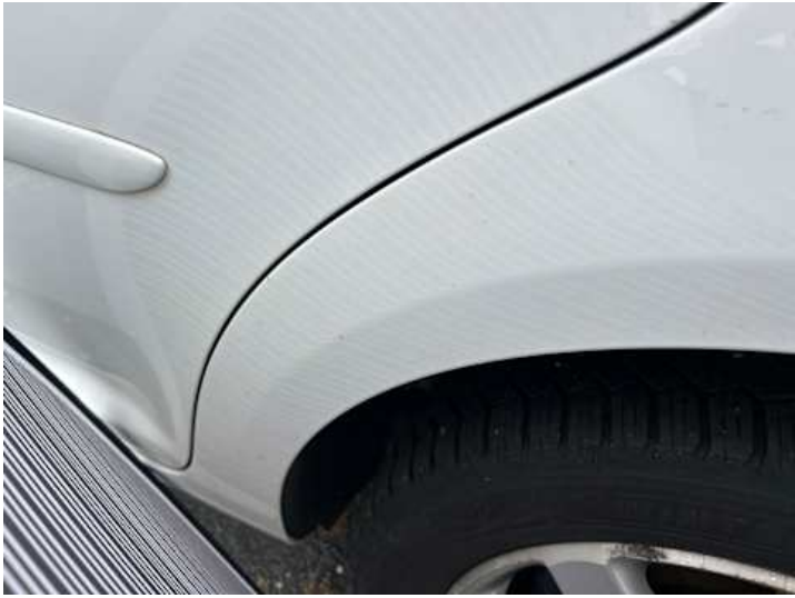
Seitenteil hinten links (Delle)
