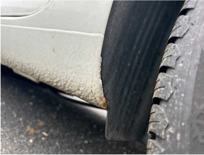
Schweller links (Rost, Verformung)
