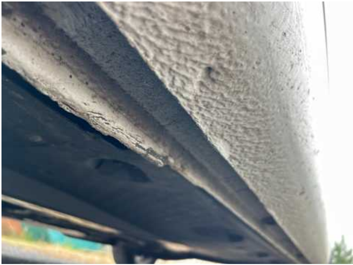
Schweller links (Rost, Verformung)
