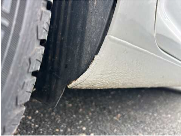
Schweller rechts (Rost)
