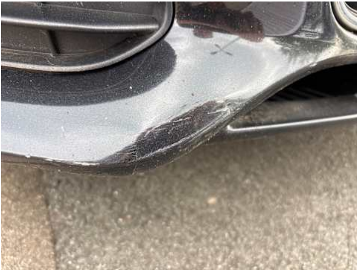
Stoßstange vorne (Lackschaden, Verformung)
