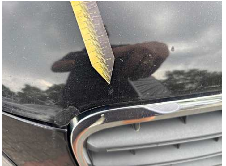
Motorhaube (Steinschlag, Unsachgemäß instand gesetzt)
