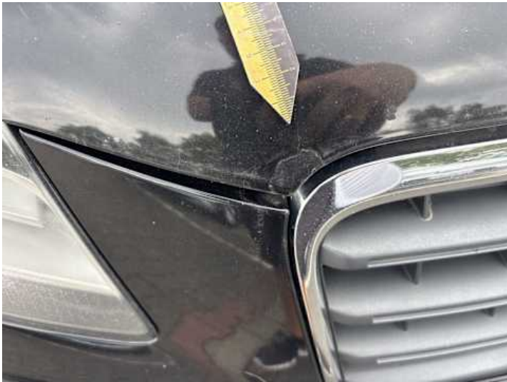
Motorhaube (Rost, Unsachgemäß instand gesetzt)
