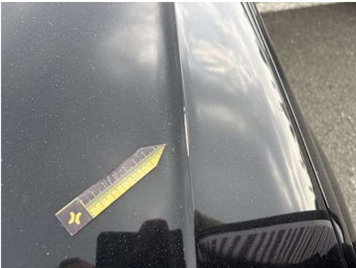
Motorhaube (Kratzer, Lackschaden)
