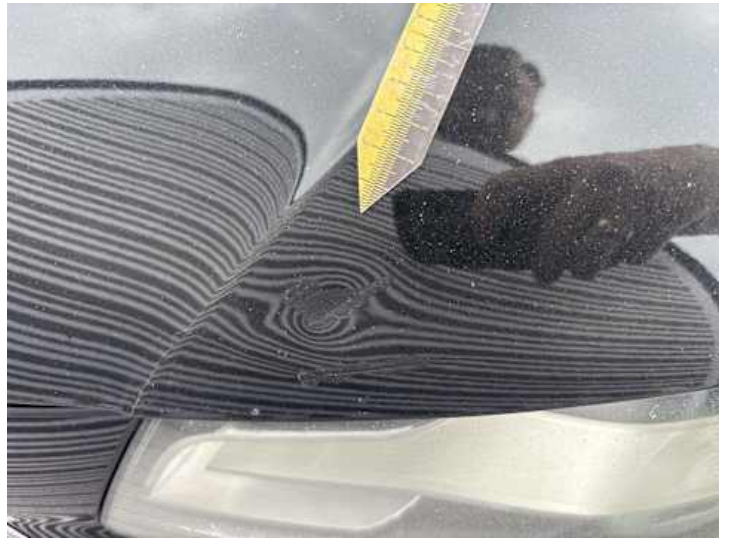
Motorhaube (Kratzer, Unsachgemäß instand gesetzt, Delle)
