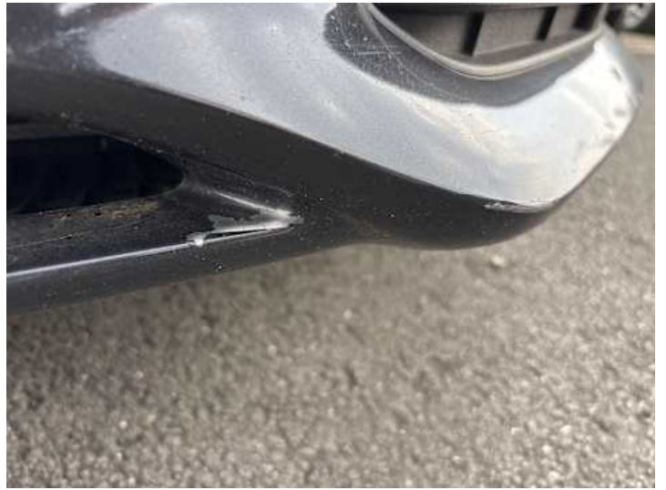
Stoßstange vorne (Lackschaden, Verformung)
