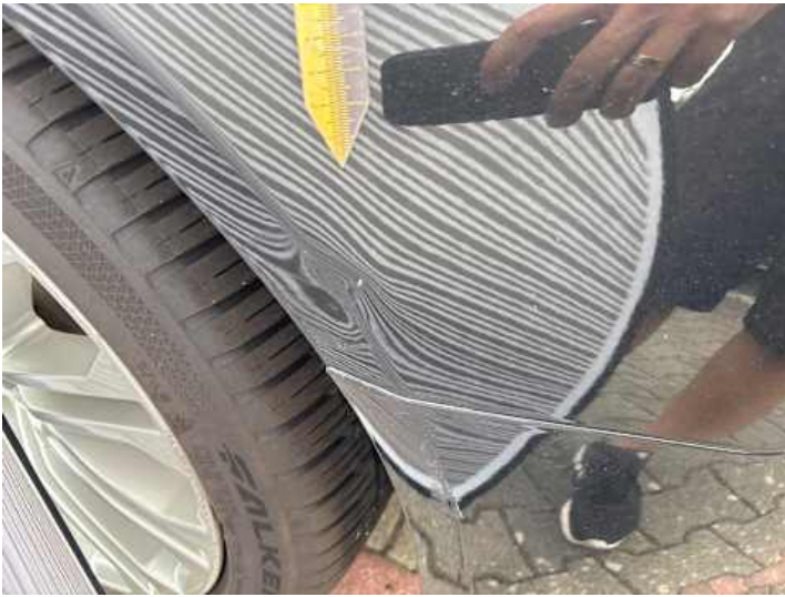
Kotflügel vorne rechts (Delle, Kratzer)
