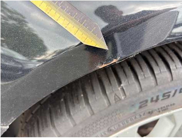
Kotflügel vorne links (Lackschaden, Rost)
