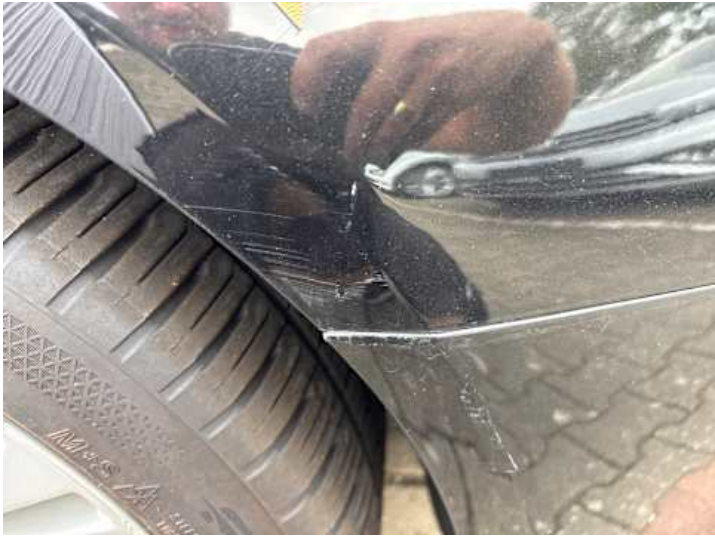
Kotflügel vorne rechts (Delle, Kratzer)
