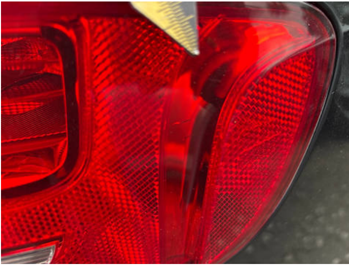
Rücklicht (rechts) (Riss/Bruch)
