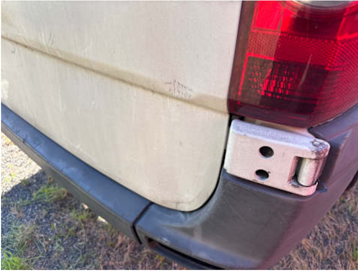
Heckklappe (Verformung, Kratzer, Lackschaden, Rost, Delle)
