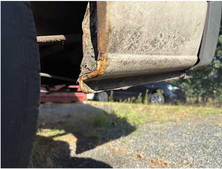
Schweller links (Rost, Lackschaden, Verformung)
