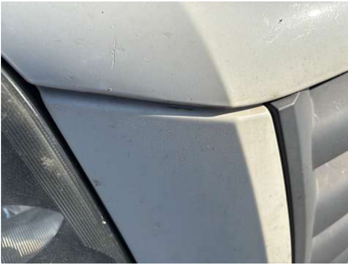
Stoßstange vorne (Kratzer, Lackschaden, Delle)
