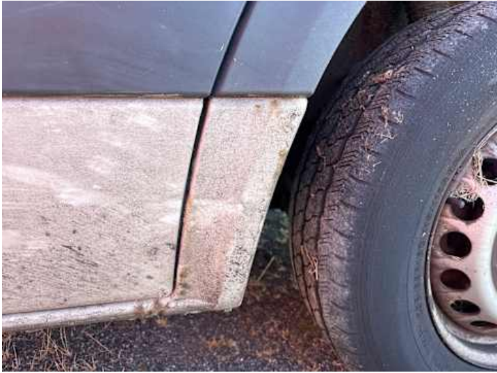
Schweller rechts (Rost, Lackschaden, Verformung)
