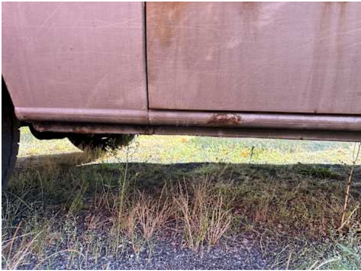
Schweller rechts (Rost, Lackschaden, Verformung)
