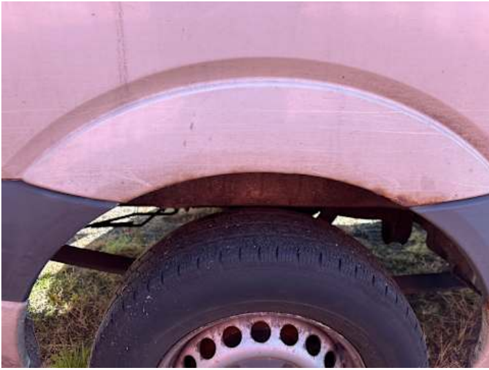
Seitenteil hinten rechts (Rost, Kratzer, Lackschaden, Verformung)
