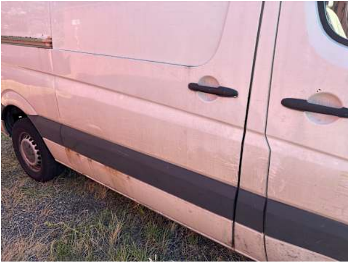
Türe hinten rechts (Rost, Lackschaden, Kratzer, Anderer Schaden): Tür öffnet nicht
