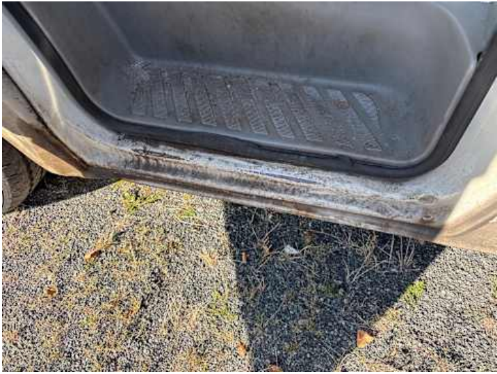
Schweller links (Rost, Lackschaden, Verformung)
