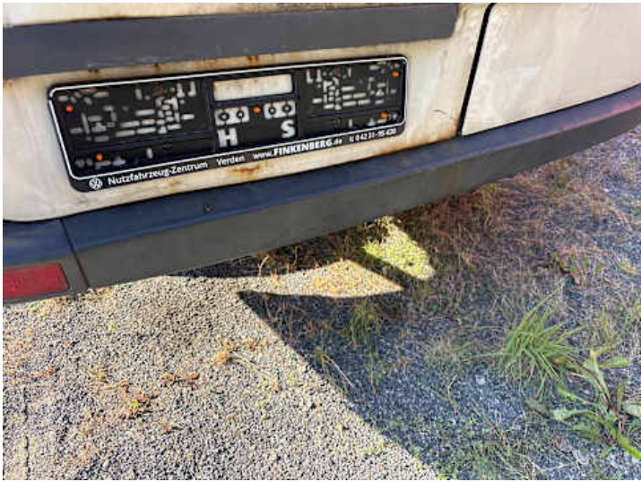
Stoßstange hinten (Kratzer, Lackschaden, Riss/Bruch)
