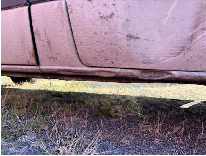
Schweller rechts (Rost, Lackschaden, Verformung)
