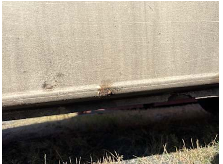
Schweller links (Rost, Lackschaden, Verformung)
