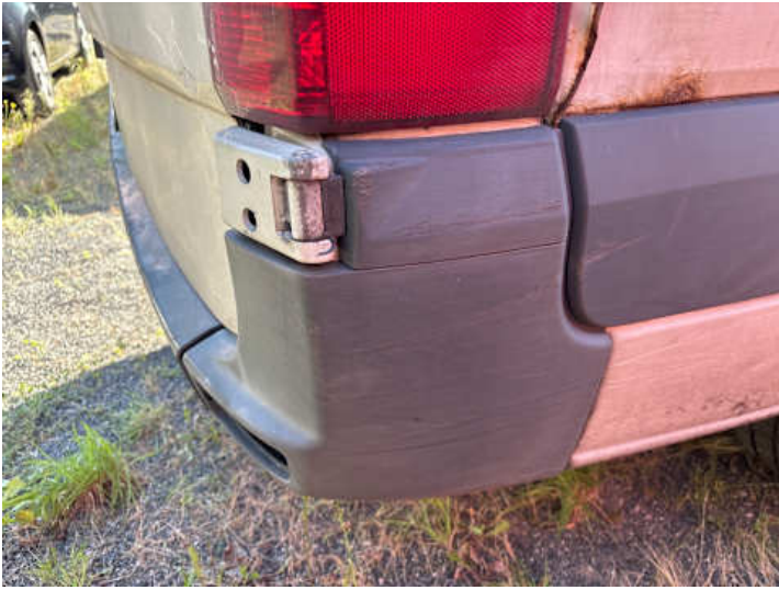
Stoßstange hinten (Kratzer, Lackschaden, Riss/Bruch)
