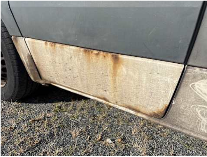
Fahrtür (Lackschaden, Kratzer, Rost)
