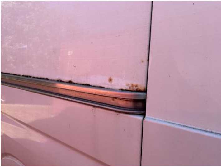
Seitenteil hinten rechts (Rost, Kratzer, Lackschaden, Verformung)
