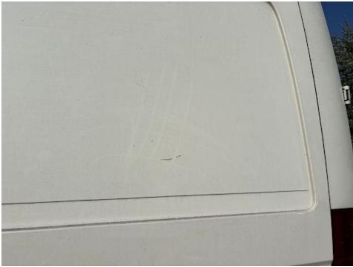
Seitenteil hinten links (Rost, Kratzer, Lackschaden)
