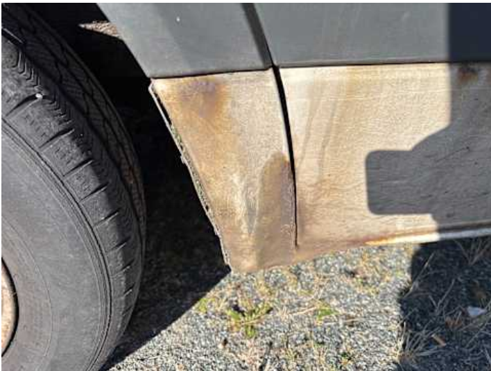
Schweller links (Rost, Lackschaden, Verformung)
