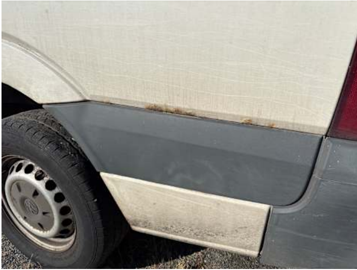
Seitenteil hinten links (Rost, Kratzer, Lackschaden)
