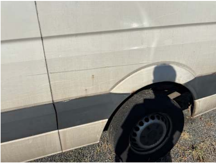
Seitenteil hinten links (Rost, Kratzer, Lackschaden)
