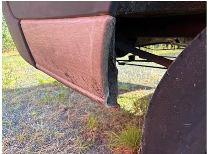
Schweller rechts (Rost, Lackschaden, Verformung)
