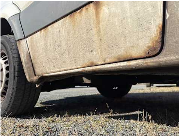
Schweller links (Rost, Lackschaden, Verformung)
