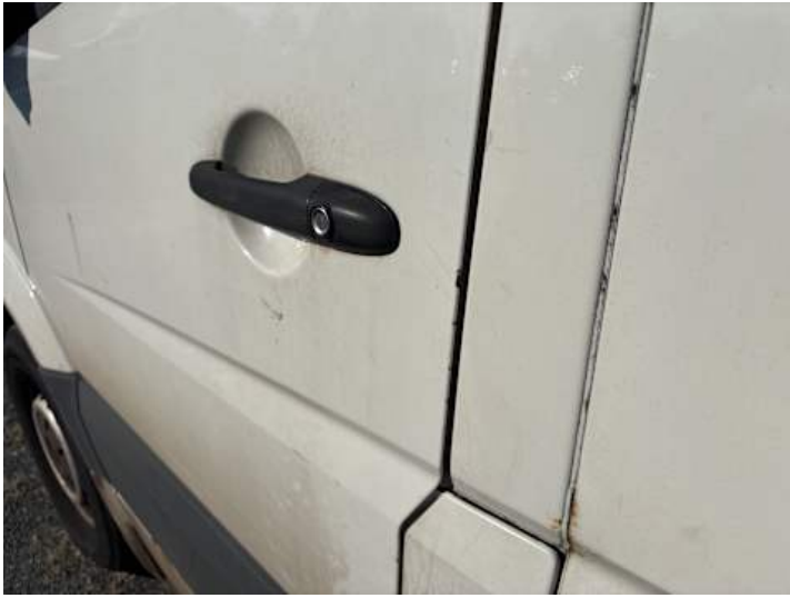
Fahrtür (Lackschaden, Kratzer, Rost)
