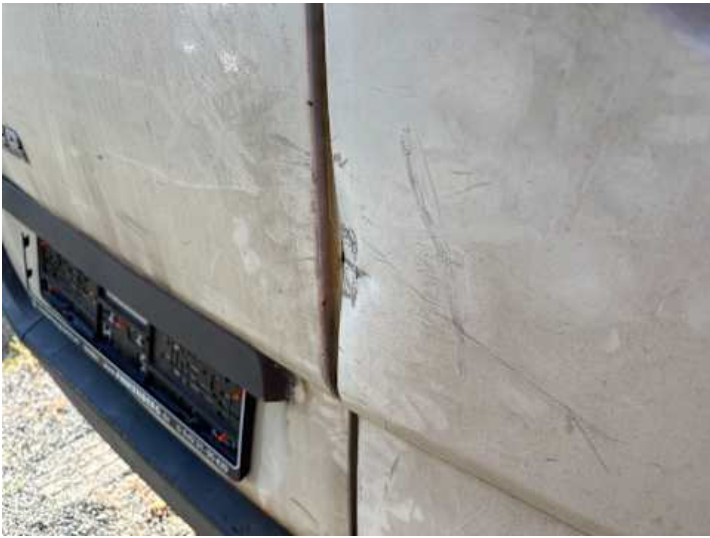
Heckklappe (Verformung, Kratzer, Lackschaden, Rost, Delle)
