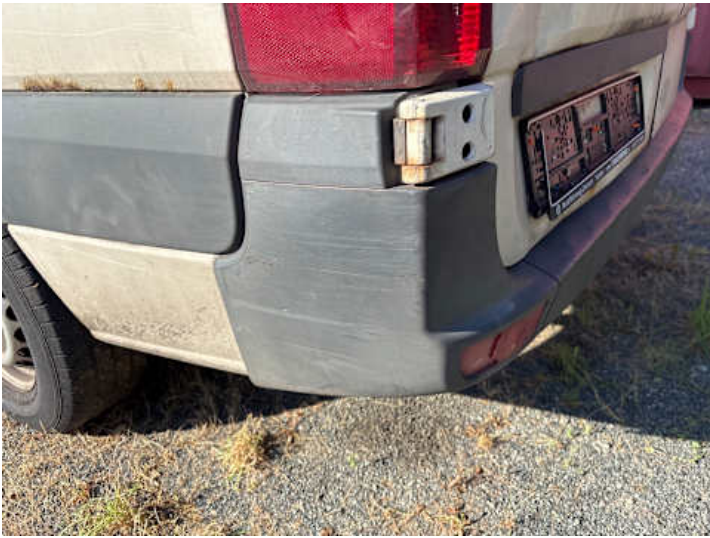
Stoßstange hinten (Kratzer, Lackschaden, Riss/Bruch)
