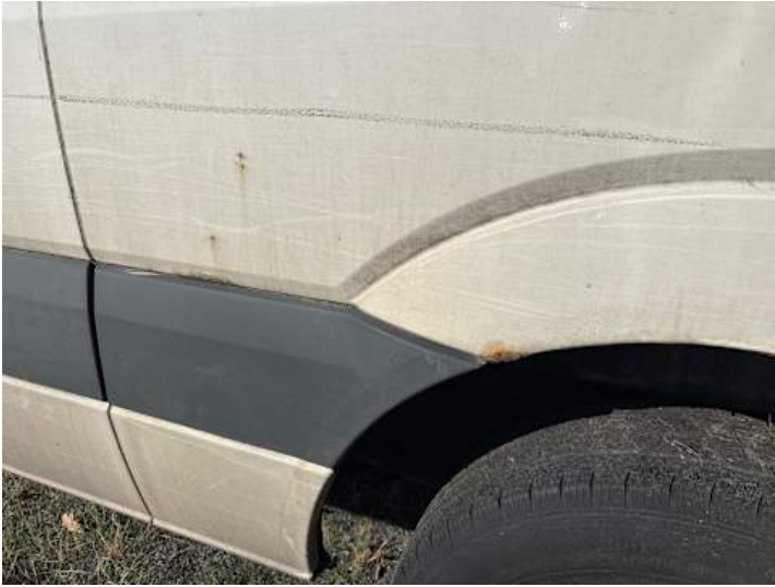
Seitenteil hinten links (Rost, Kratzer, Lackschaden)
