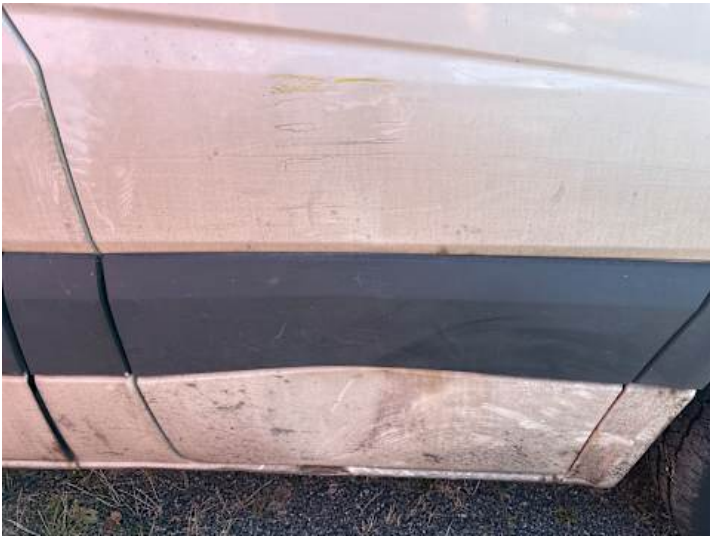
Beifahrertür (Riss/Bruch, Verformung, Kratzer, Lackschaden, Delle)
