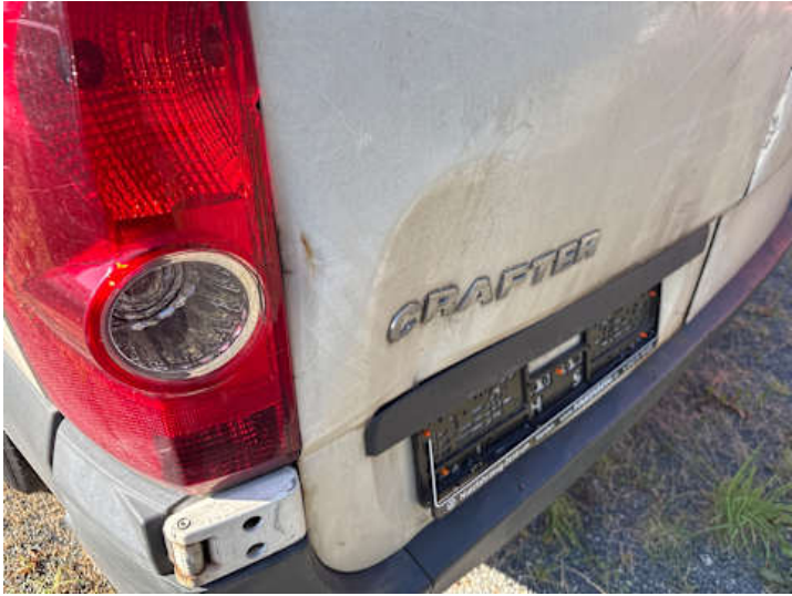
Heckklappe (Verformung, Kratzer, Lackschaden, Rost, Delle)
