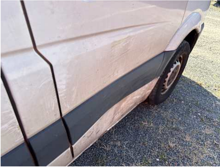
Beifahrertür (Riss/Bruch, Verformung, Kratzer, Lackschaden, Delle)
