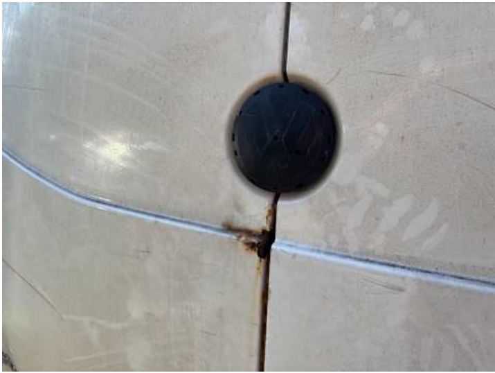
Heckklappe (Verformung, Kratzer, Lackschaden, Rost, Delle)
