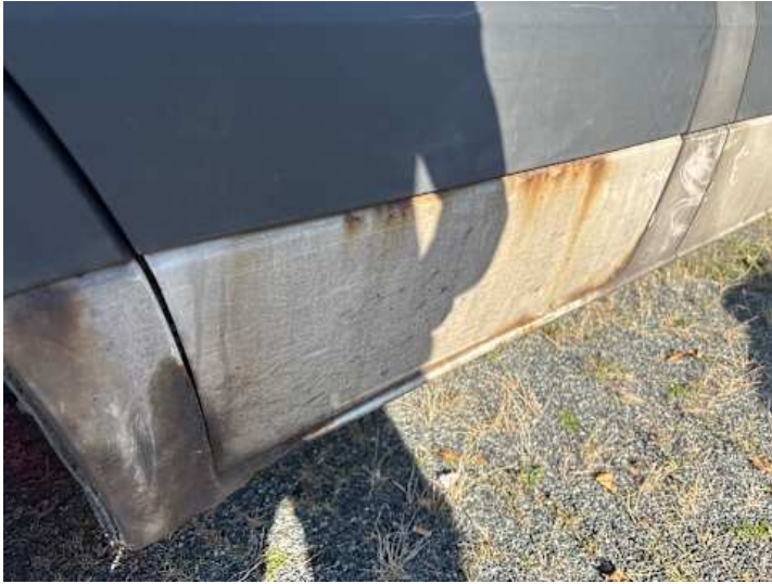
Fahrtür (Lackschaden, Kratzer, Rost)
