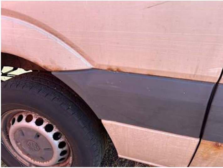
Seitenteil hinten rechts (Rost, Kratzer, Lackschaden, Verformung)
