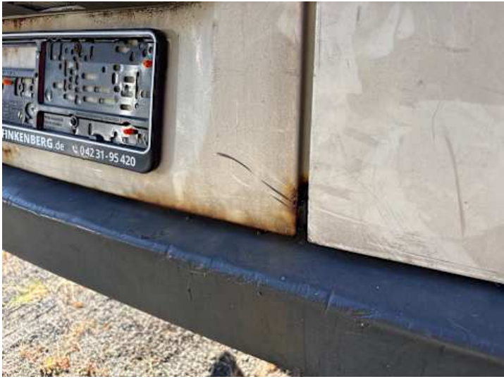
Heckklappe (Verformung, Kratzer, Lackschaden, Rost, Delle)
