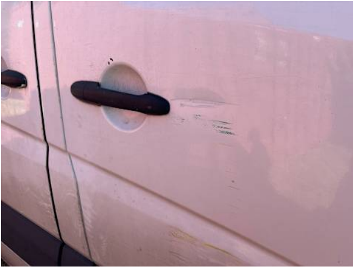
Beifahrertür (Riss/Bruch, Verformung, Kratzer, Lackschaden, Delle)
