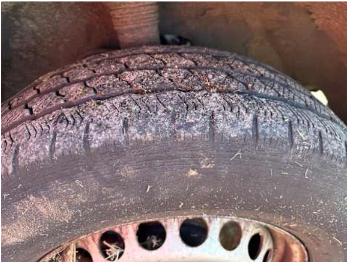
Rad (Ungleichmäßig abgefahren, vehicle.damage-label.porous)
