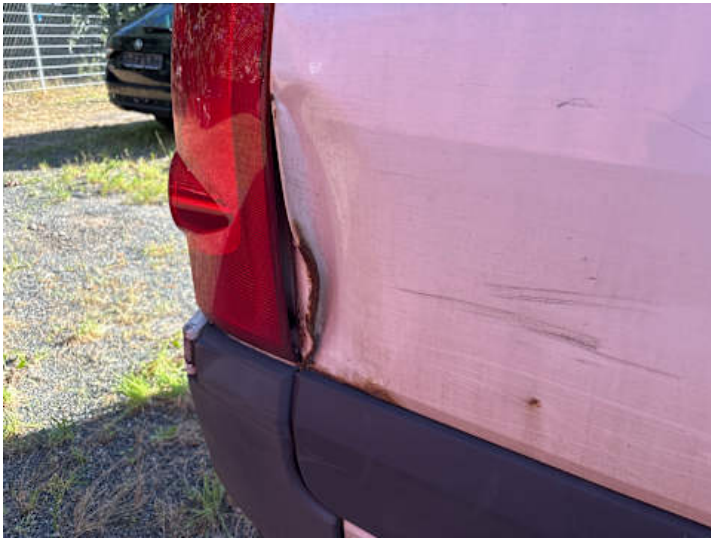
Seitenteil hinten rechts (Rost, Kratzer, Lackschaden, Verformung)
