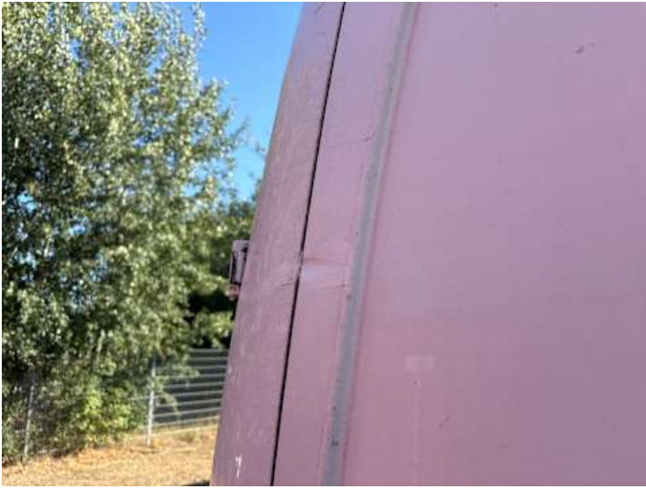
Seitenteil hinten rechts (Rost, Kratzer, Lackschaden, Verformung)
