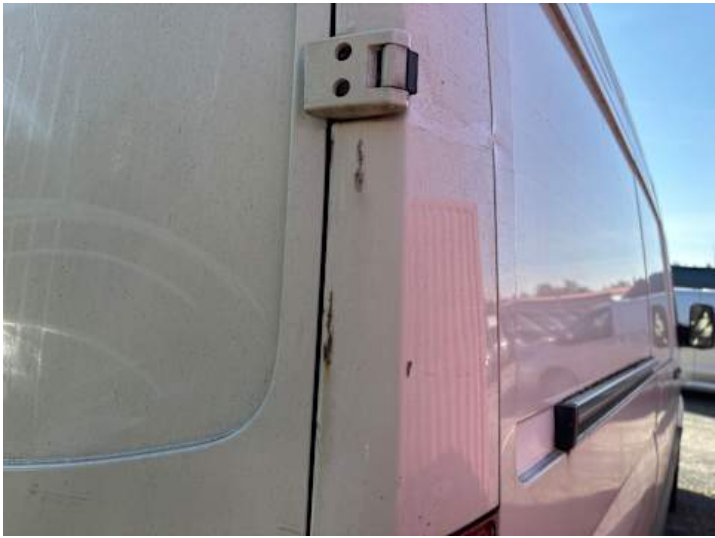
Heckklappe (Verformung, Kratzer, Lackschaden, Rost, Delle)
