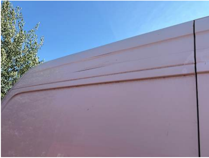
Seitenteil hinten rechts (Rost, Kratzer, Lackschaden, Verformung)
