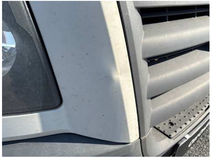
Stoßstange vorne (Kratzer, Lackschaden, Delle)
