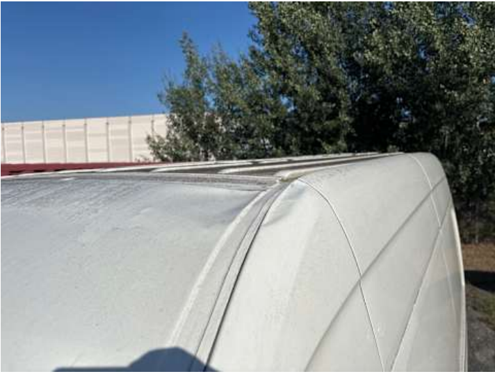
Dach (Verformung, Delle, Kratzer)
