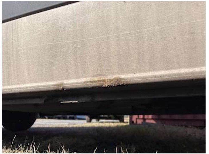
Schweller links (Rost, Lackschaden, Verformung)
