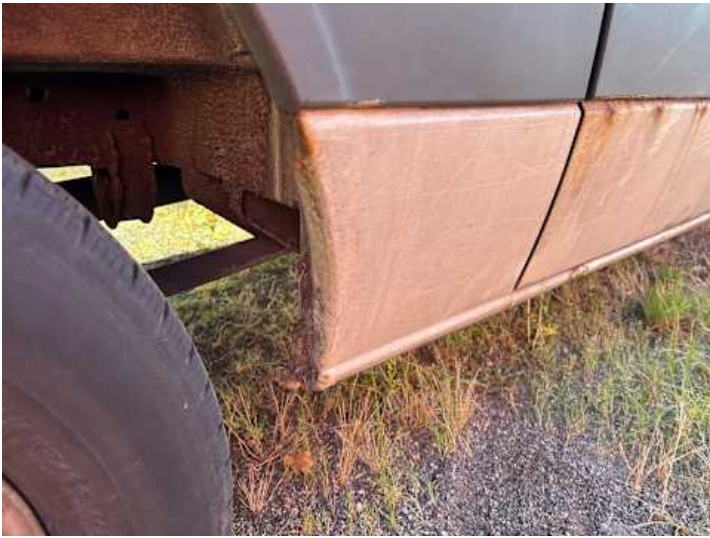
Schweller rechts (Rost, Lackschaden, Verformung)
