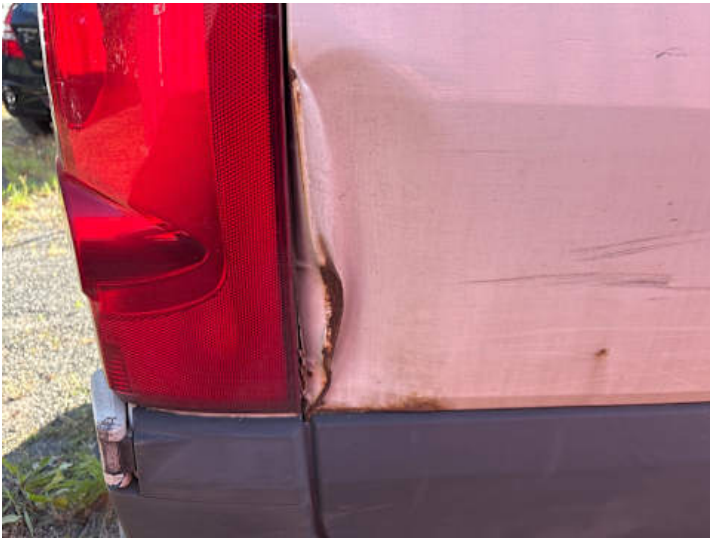
Seitenteil hinten rechts (Rost, Kratzer, Lackschaden, Verformung)
