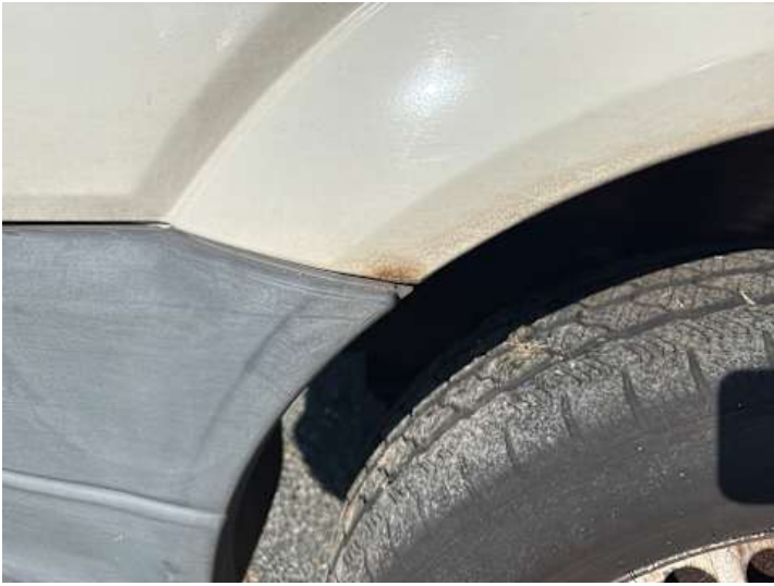
Kotflügel vorne links (Rost)
