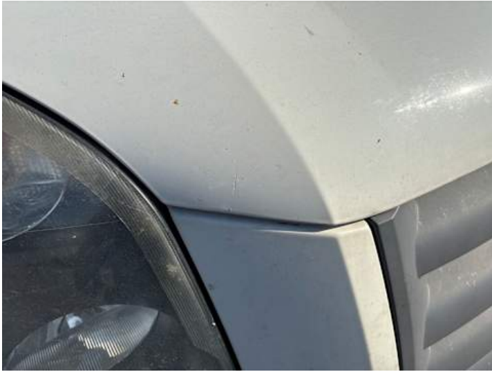
Motorhaube (Lackschaden, Kratzer)
