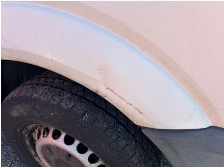
Kotflügel vorne rechts (Kratzer, Lackschaden, Delle, Rost)
