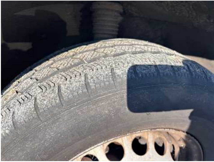
Rad (Ungleichmäßig abgefahren, vehicle.damage-label.porous)
