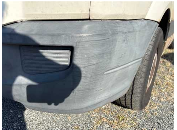
Stoßstange vorne (Kratzer, Lackschaden, Delle)
