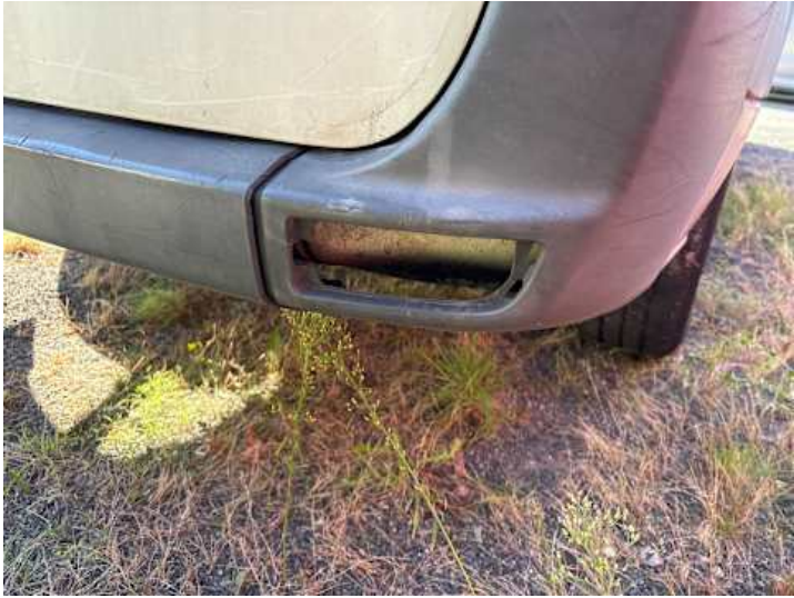
Stoßstange hinten (Kratzer, Lackschaden, Riss/Bruch)
