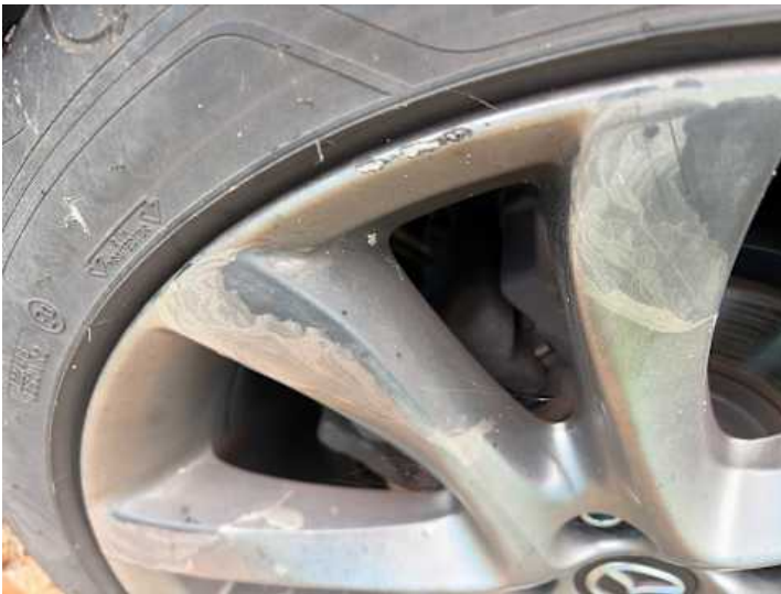
Rad (Kerben, Kratzer, Anderer Schaden): Beschichtung löst sich
