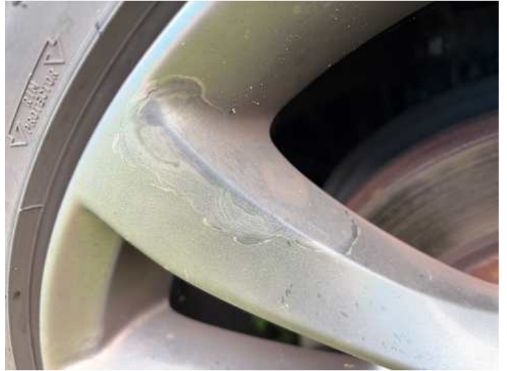
Rad (Anderer Schaden): Beschichtung löst sich
