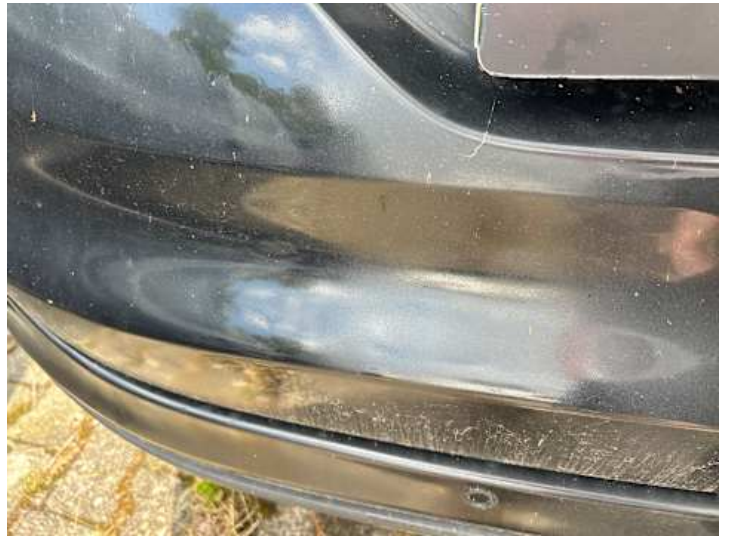
Heckklappe (Unsachgemäß instand gesetzt)
