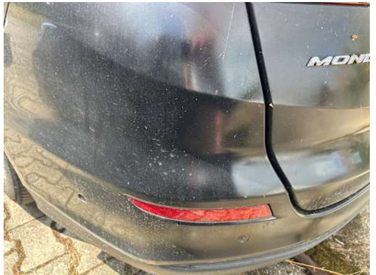
Stoßstange hinten (Unsachgemäß instand gesetzt)
