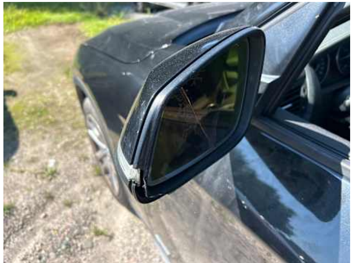
Fahrtür (Anderer Schaden): Spiegel defekt (Glas Verstellung und Kappe)
