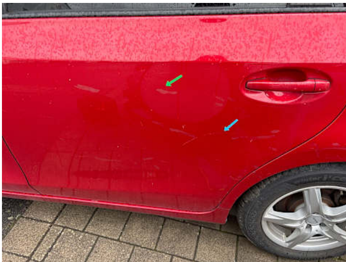
Türe hinten links (Kratzer, Unsachgemäß instand gesetzt)
