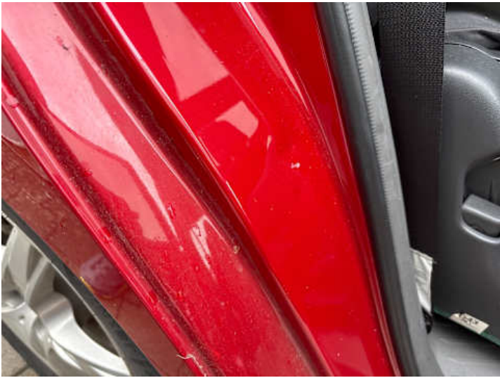
Seitenteil hinten rechts (Delle, Lackschaden)
