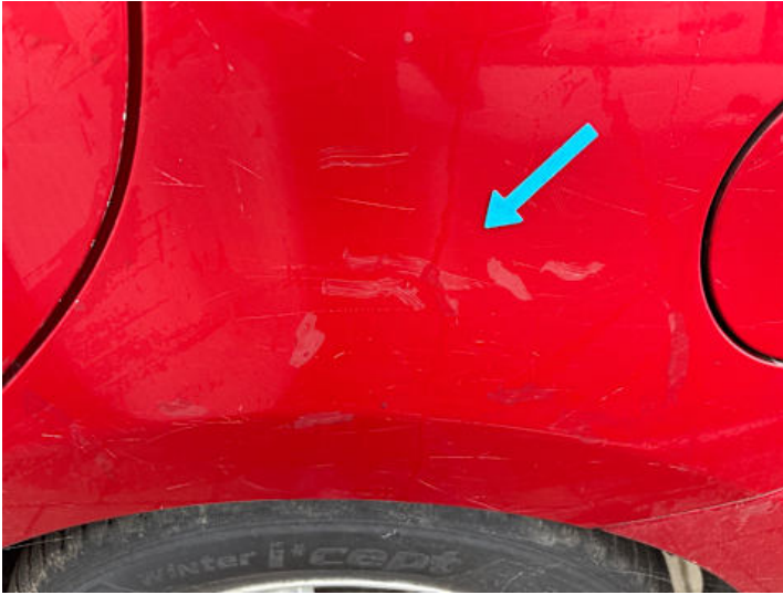
Seitenteil hinten links (Unsachgemäß instand gesetzt, Kratzer)
