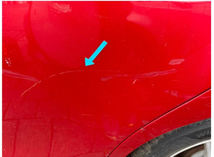
Türe hinten links (Kratzer, Unsachgemäß instand gesetzt)
