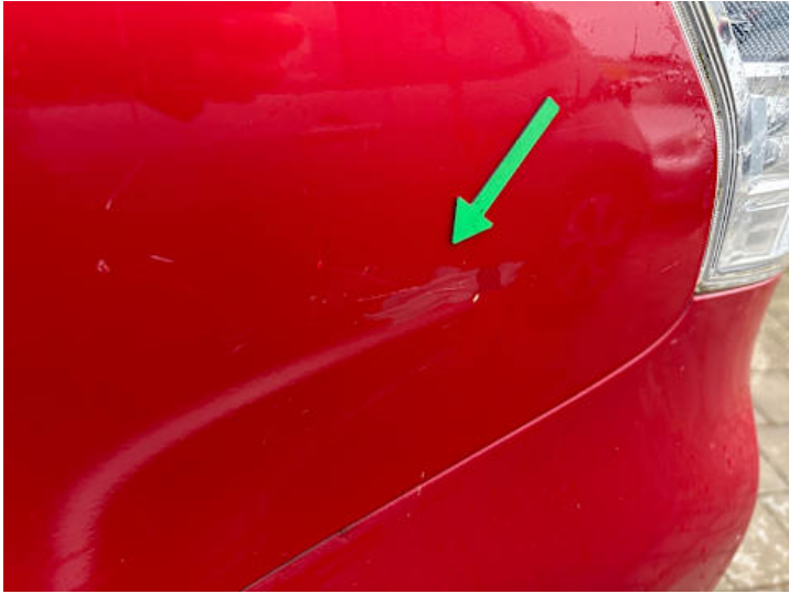
Seitenteil hinten links (Unsachgemäß instand gesetzt, Kratzer)
