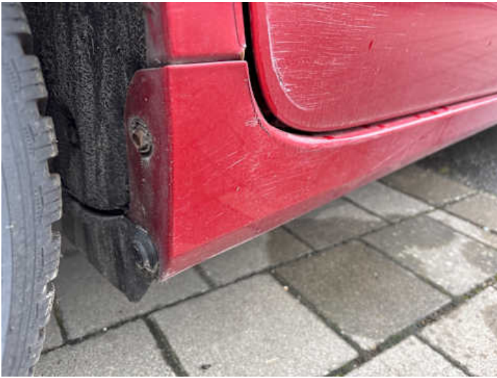
Schweller rechts (Lackschaden, Verformung)
