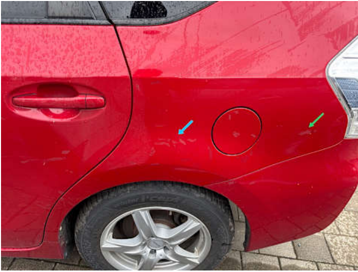
Seitenteil hinten links (Unsachgemäß instand gesetzt, Kratzer)
