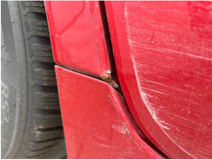
Seitenteil hinten rechts (Rost, Delle)
