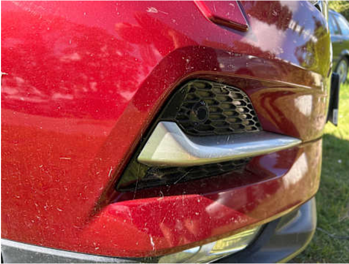
Stoßstange vorne (Spaltmaße ungenau)
