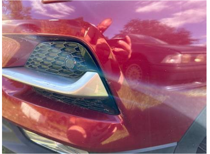
Stoßstange vorne (Spaltmaße ungenau)
