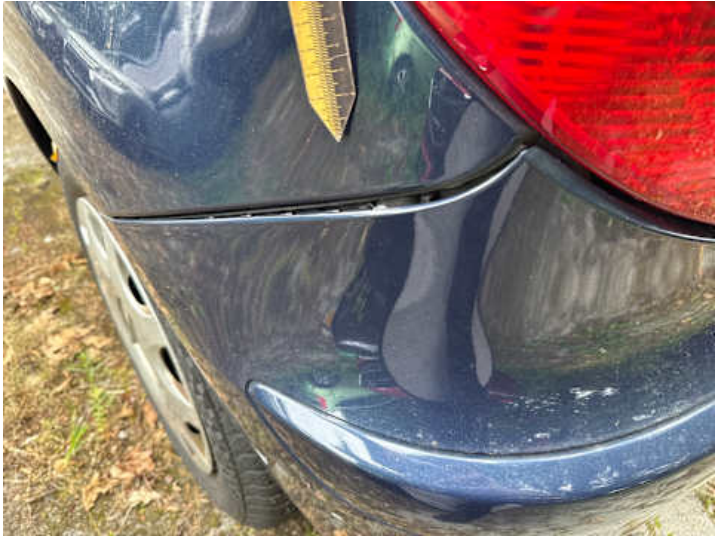
Stoßstange hinten (Spaltmaße ungenau)
