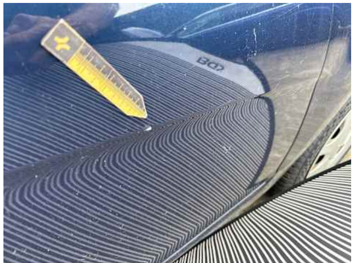
Beifahrtür (Delle, Lackschaden)
