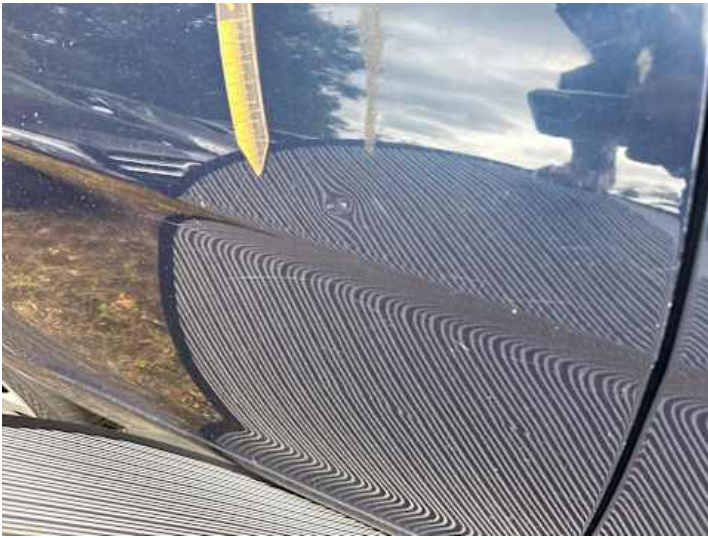
Türe hinten rechts (Delle, Kratzer)
