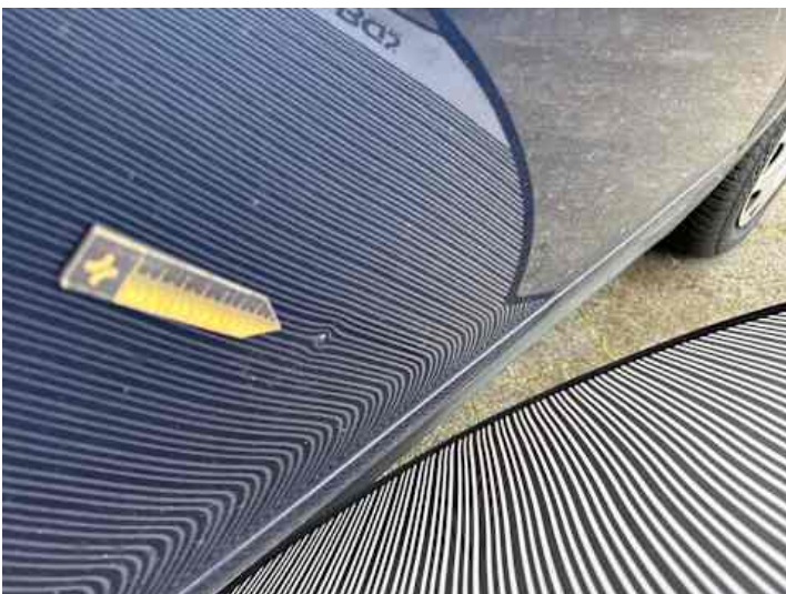
Beifahrtür (Delle, Lackschaden)
