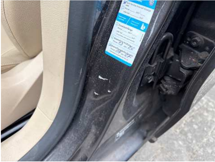
Schweller links (Lackschaden, Delle)
