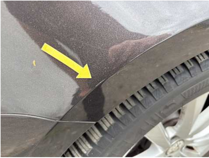
Kotflügel vorne links (Kratzer)
