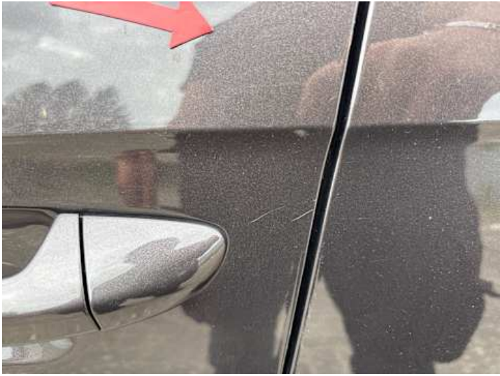
Fahrtür (Lackschaden, Kratzer)
