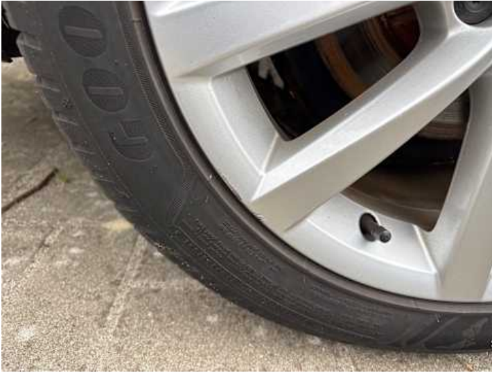
Rad (vehicle.damage-label.porous, Kratzer, Kerben)
