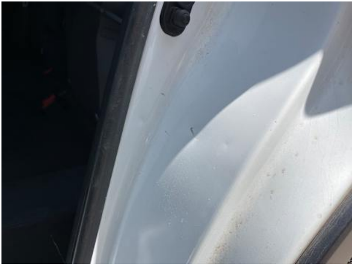
Türe hinten links (Kratzer, Lackschaden, Delle)
