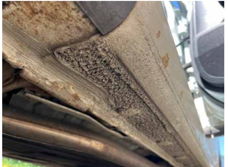
Schweller rechts (Rost, Lackschaden)
