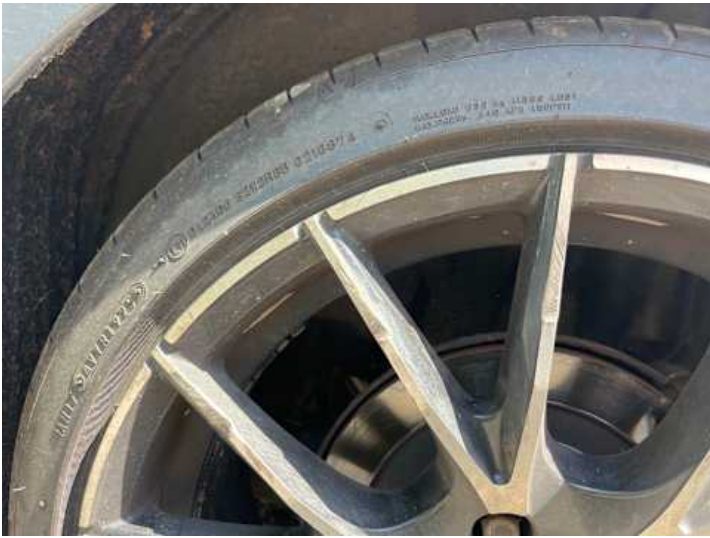
Rad (Kratzer, Kerben, Verformung)
