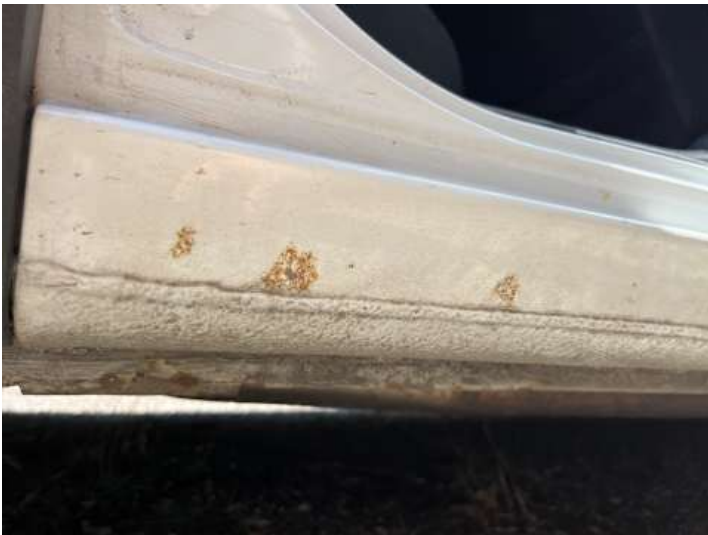
Schweller rechts (Rost, Lackschaden)
