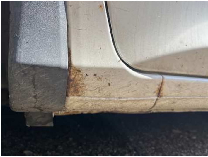
Kotflügel vorne links (Lackschaden, Rost)
