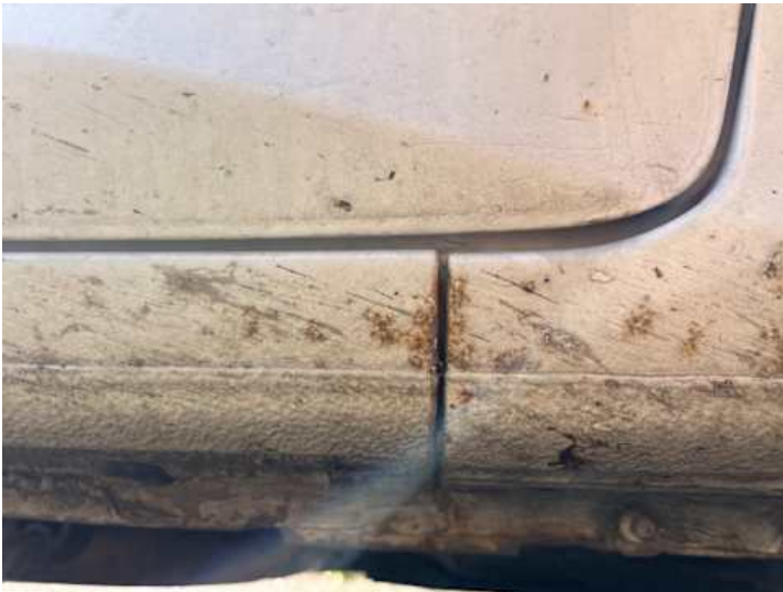
Schweller rechts (Rost, Lackschaden)
