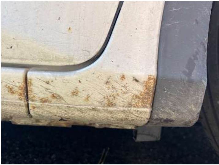
Kotflügel vorne rechts (Lackschaden, Rost)
