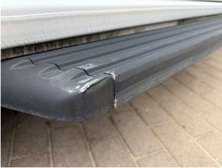
Schweller rechts (Kratzer)
