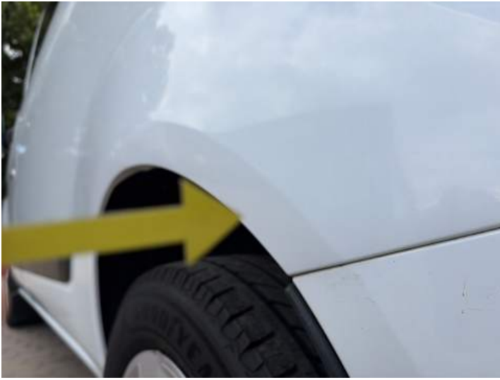
Seitenteil hinten links (Lackschaden, Kratzer, Unsachgemäß instand gesetzt)
