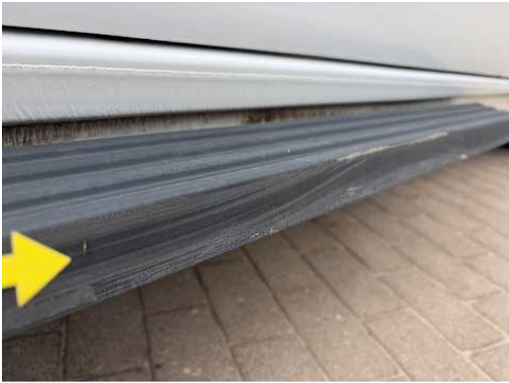
Schweller rechts (Kratzer)
