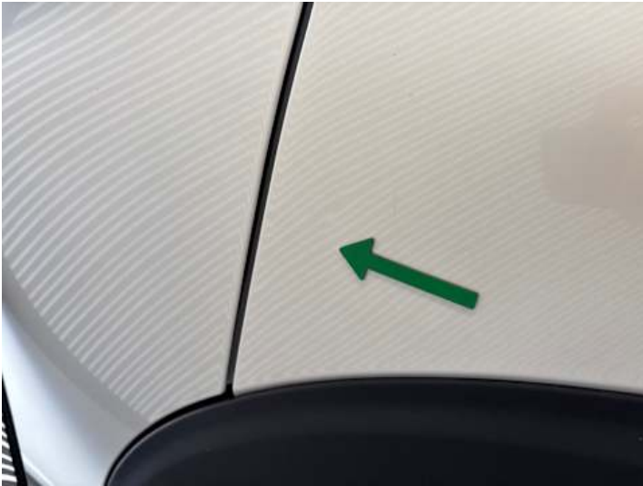
Seitenteil hinten links (Delle)
