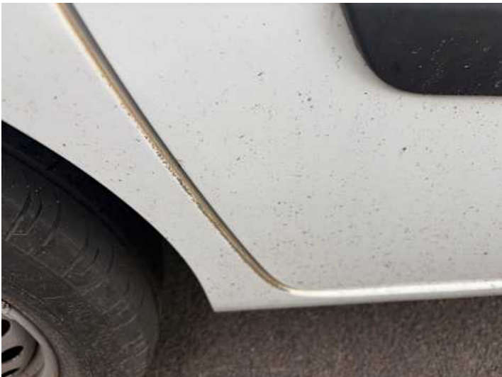
Seitenteil hinten rechts (Kratzer, Lackschaden, Rost)
