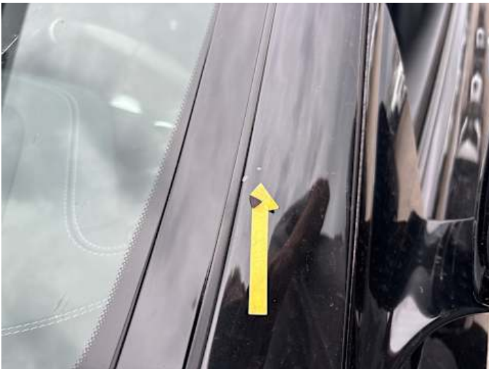
Seitenteil hinten links (Steinschlag)
