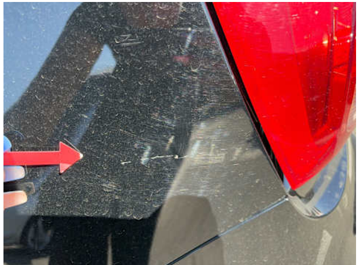
Seitenteil hinten links (Lackschaden)
