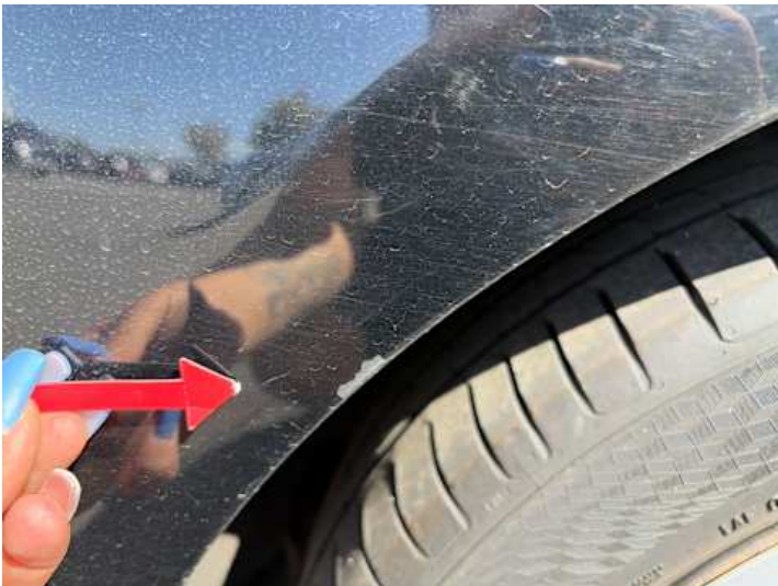
Seitenteil hinten links (Lackschaden)
