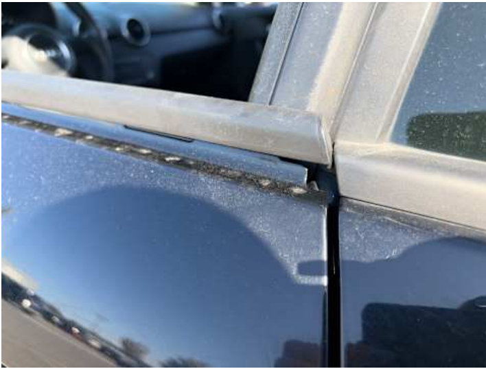
Fahrertür (Anderer Schaden): Dichtung nicht befestigt
