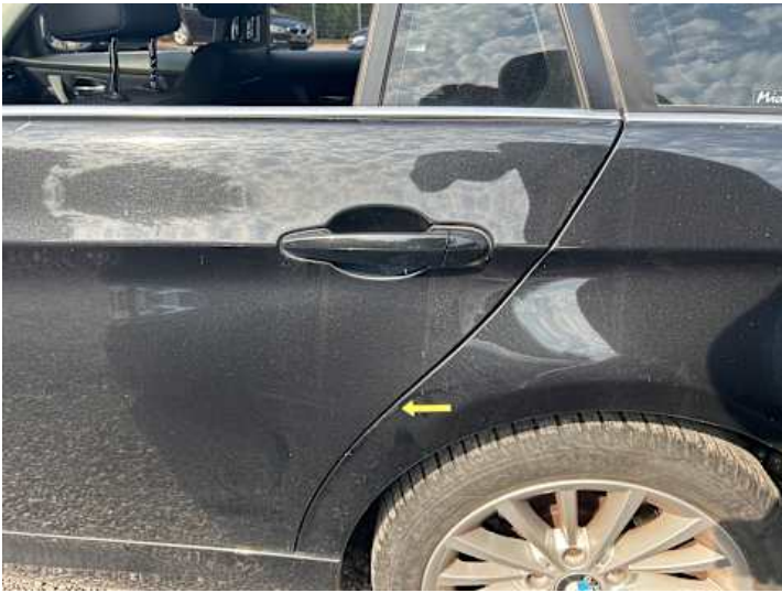
Seitenteil hinten links (Lackschaden)
