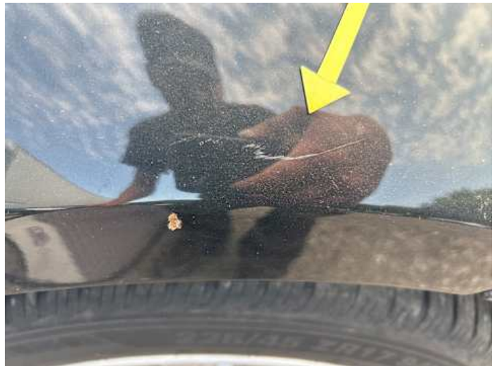
Kotflügel vorne rechts (Kratzer, Lackschaden)
