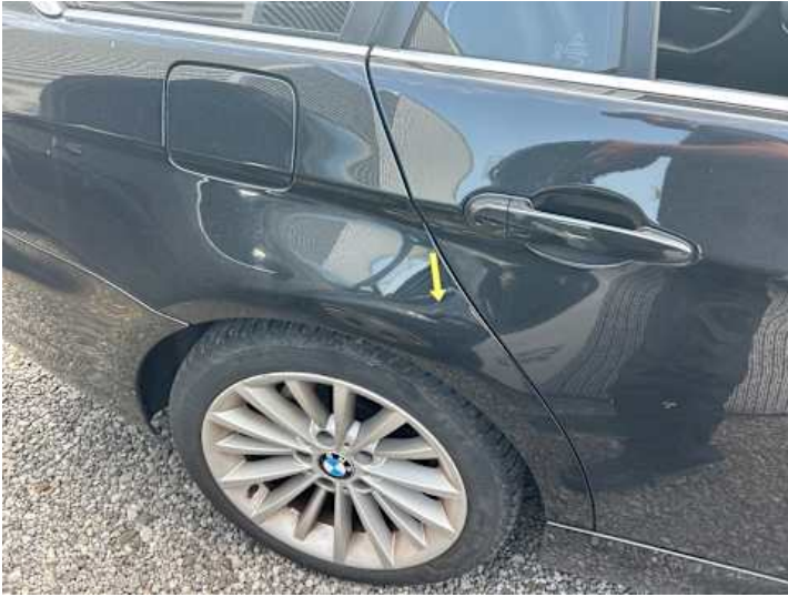
Seitenteil hinten rechts (Lackschaden)
