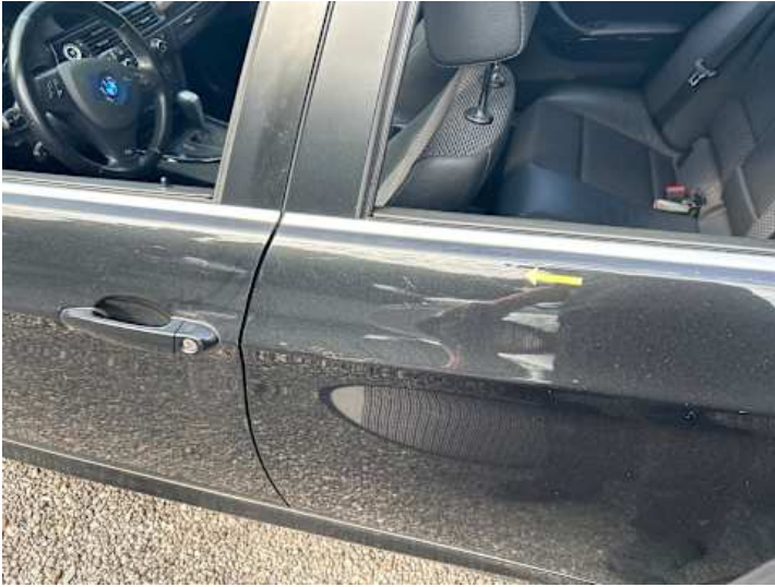
Türe hinten links (Kratzer, Lackschaden)
