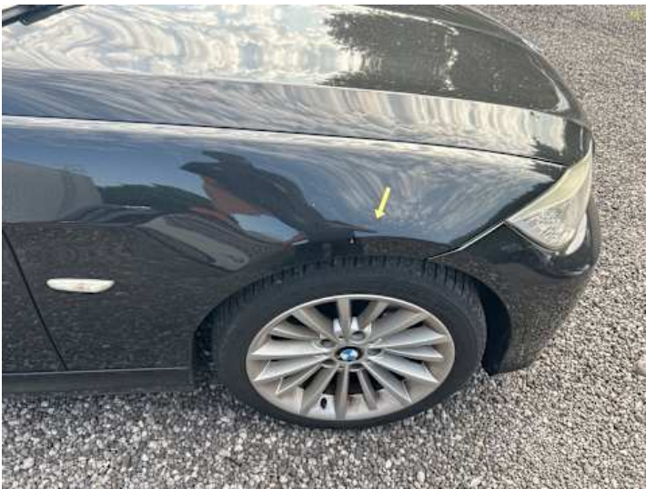
Kotflügel vorne rechts (Kratzer, Lackschaden)
