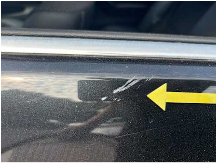
Türe hinten links (Kratzer, Lackschaden)
