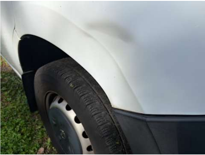
Kotflügel vorne rechts (Delle, Lackschaden)
