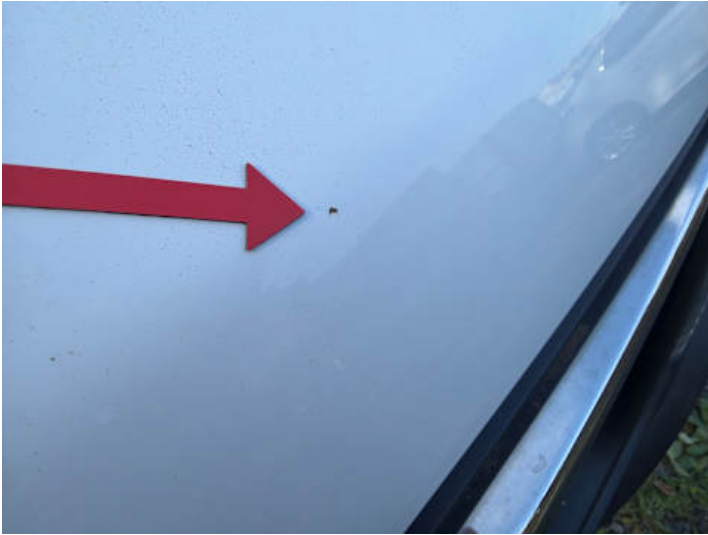
Motorhaube (Lackschaden, Rost)
