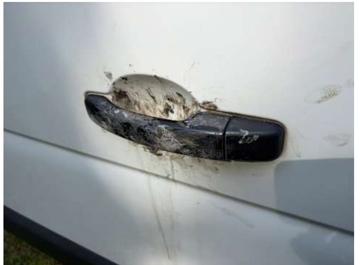
Türe hinten rechts (Kratzer, Anderer Schaden): Tür öffnet nicht Verschmutzung
