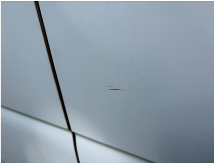
Türe hinten rechts (Kratzer, Anderer Schaden): Tür öffnet nicht Verschmutzung
