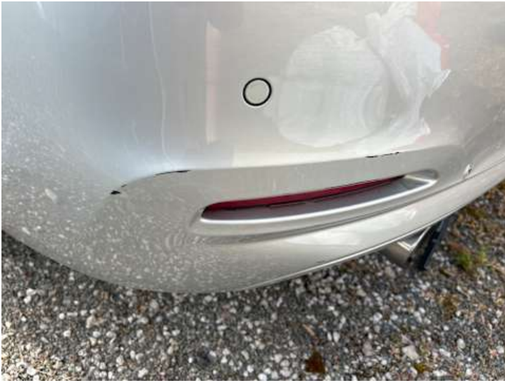
Stoßstange hinten (Riss/Bruch)
