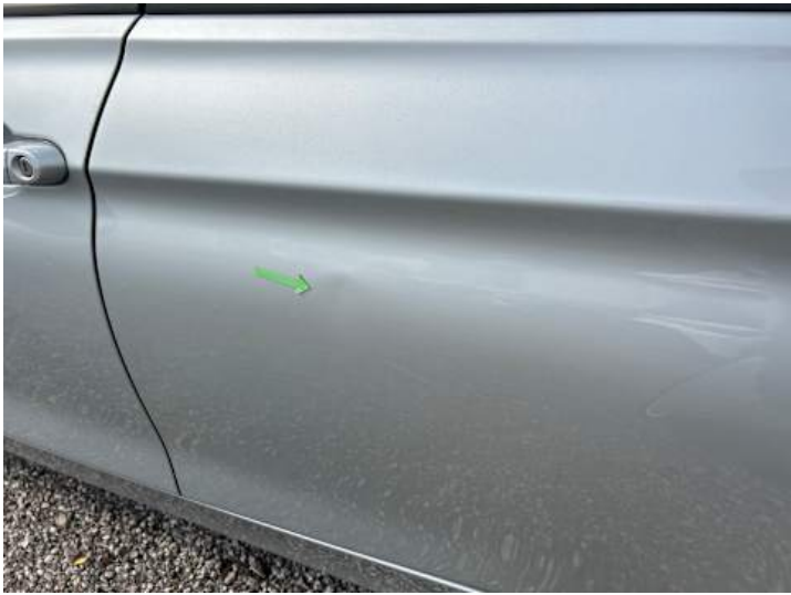
Türe hinten links (Kratzer, Verformung)
