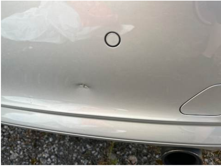
Stoßstange hinten (Riss/Bruch)
