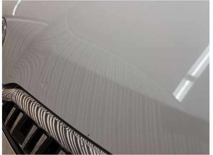
Motorhaube (Delle, Rost, Steinschlag, Lackschaden)
