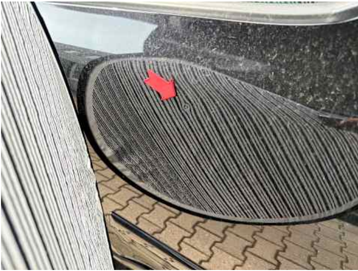
Türe hinten rechts (Delle)
