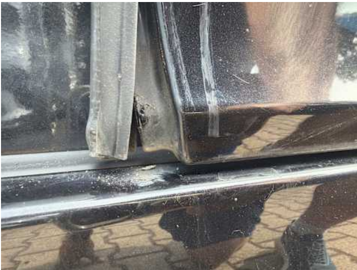
Türe hinten links (Rost)
