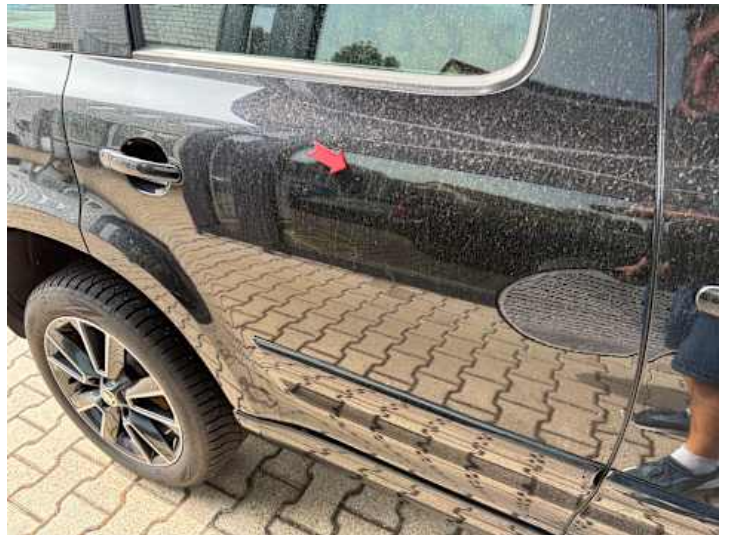
Türe hinten rechts (Delle)
