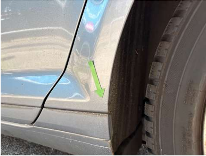
Seitenteil hinten links (Rost)
