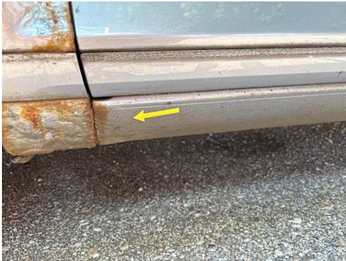
Schweller links (Rost)
