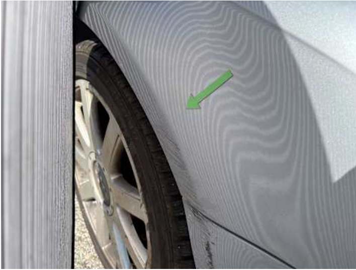
Kotflügel vorne rechts (Delle, Rost)
