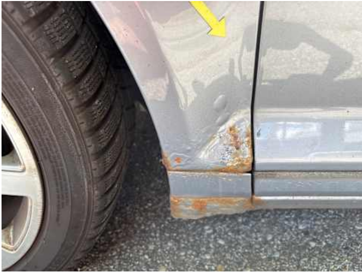
Kotflügel vorne links (Delle, Rost)
