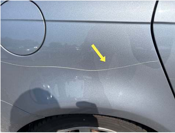
Seitenteil hinten rechts (Kratzer, Rost)
