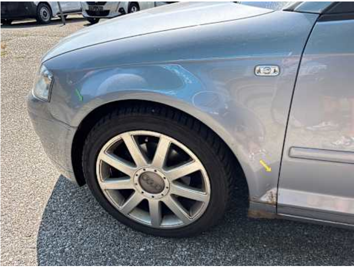
Kotflügel vorne links (Delle, Rost)
