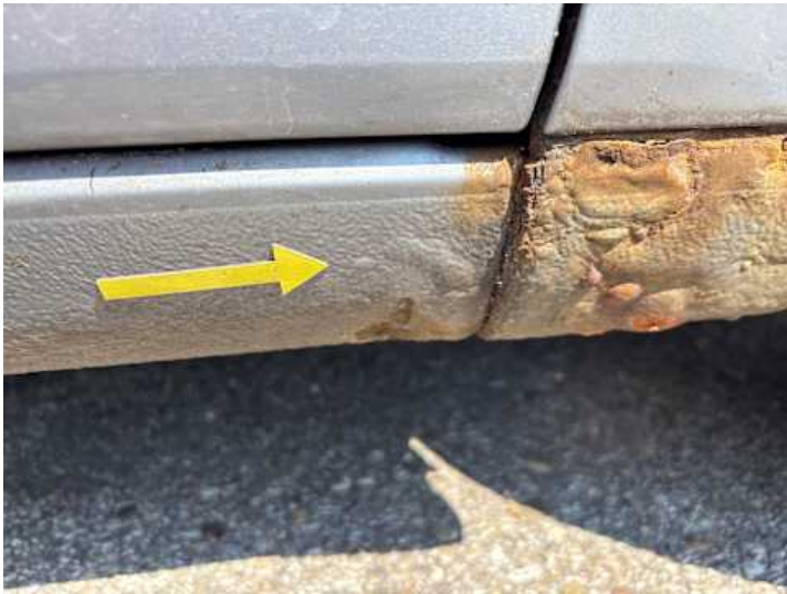
Schweller rechts (Rost)
