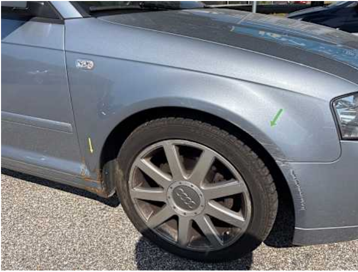
Kotflügel vorne rechts (Delle, Rost)
