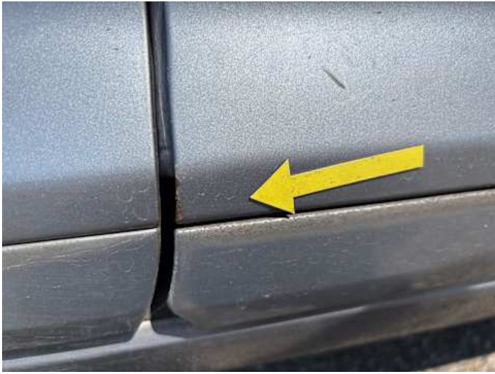
Beifahrtür (Kratzer, Rost)
