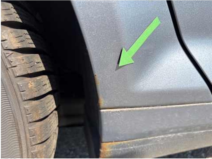
Seitenteil hinten rechts (Kratzer, Rost)
