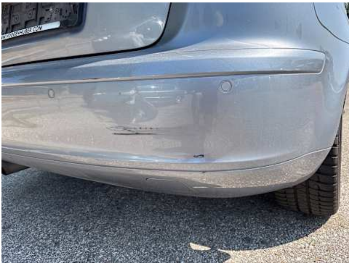
Stoßstange hinten (Riss/Bruch)
