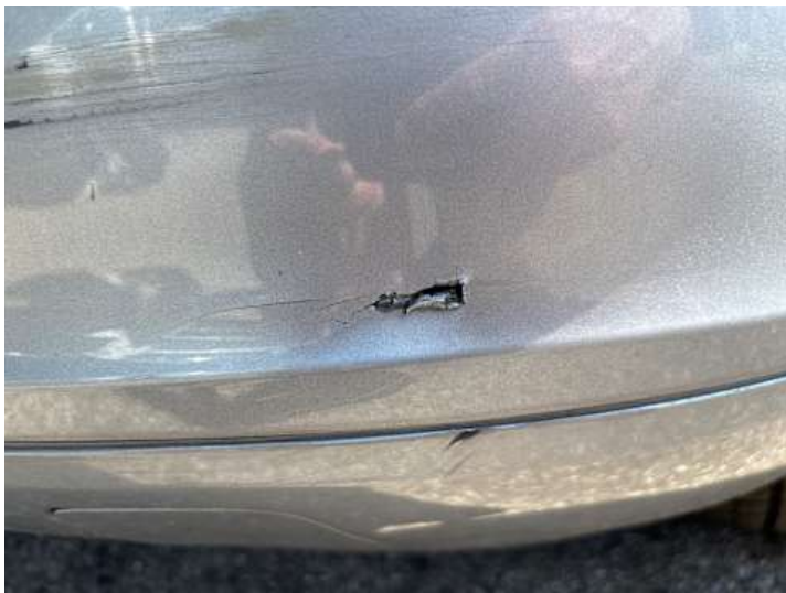
Stoßstange hinten (Riss/Bruch)
