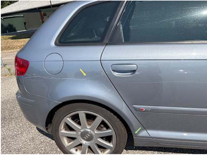
Seitenteil hinten rechts (Kratzer, Rost)
