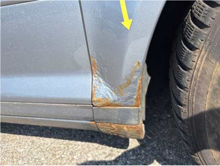
Kotflügel vorne rechts (Delle, Rost)
