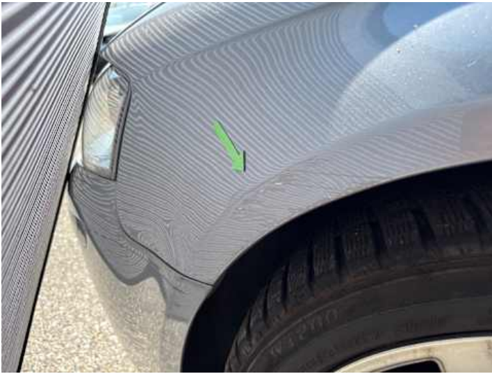
Kotflügel vorne links (Delle, Rost)
