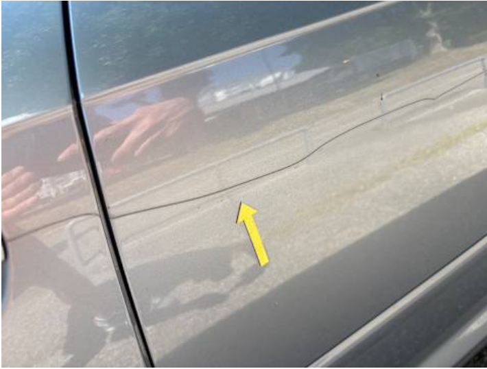
Türe hinten links (Kratzer)
