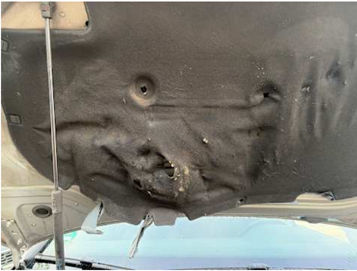
Motorhaube (Anderer Schaden): Motordämmmatte beschädigt
