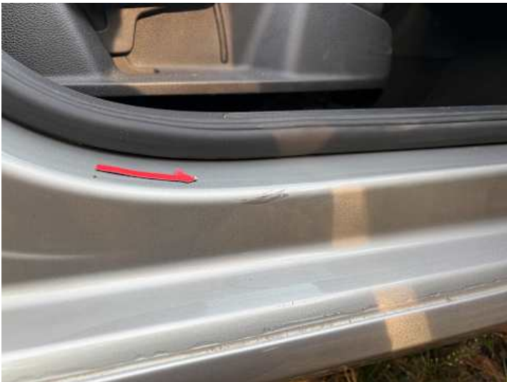
Schweller rechts (Lackschaden)
