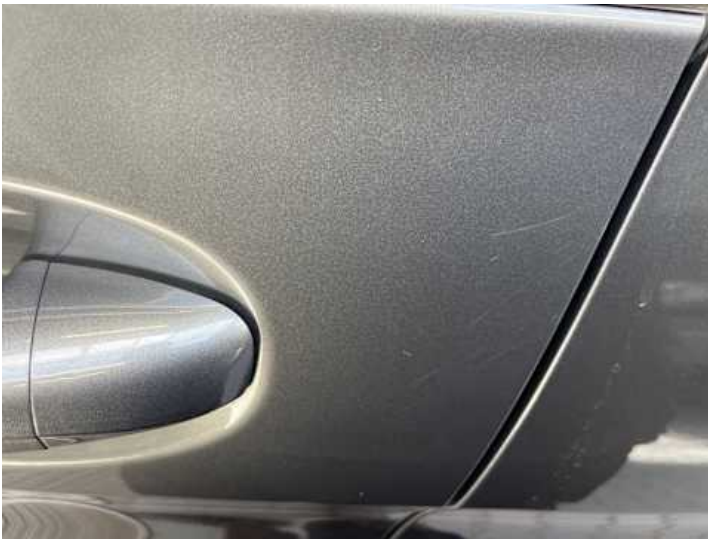
Fahrertür (Kratzer, Lackschaden)
