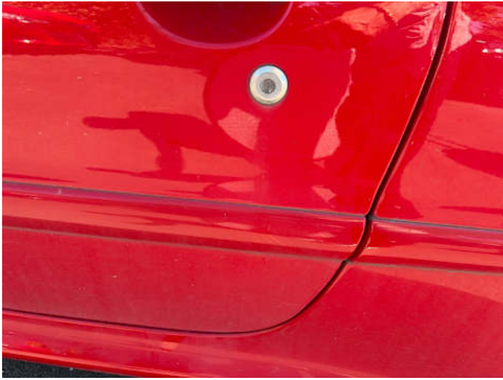
Fahrtür (Lackschaden, Kratzer)
