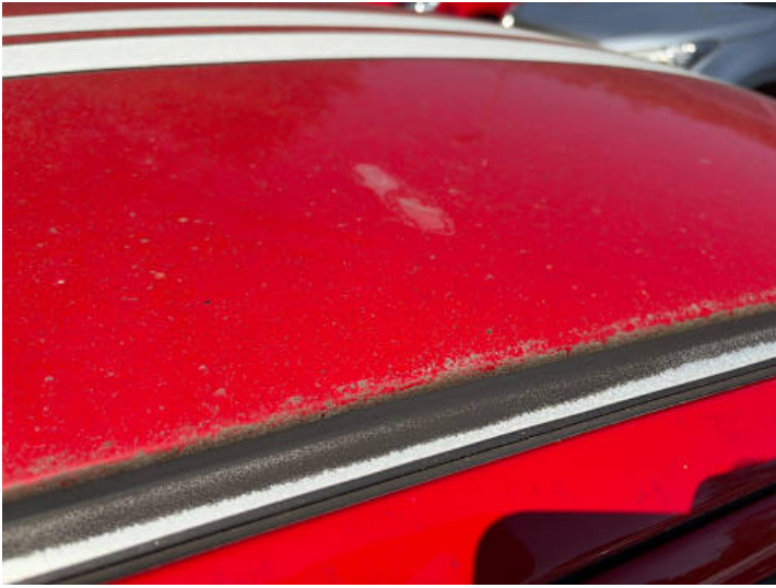
Dach (Lackschaden, Kratzer)
