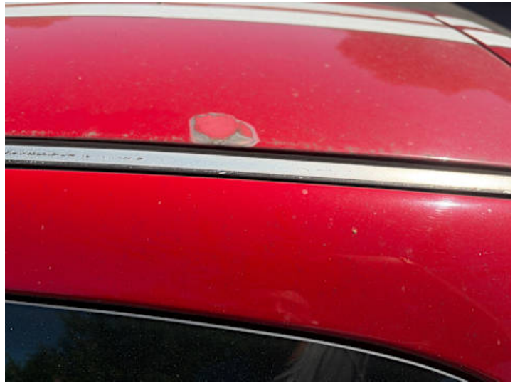
Dach (Lackschaden, Kratzer)
