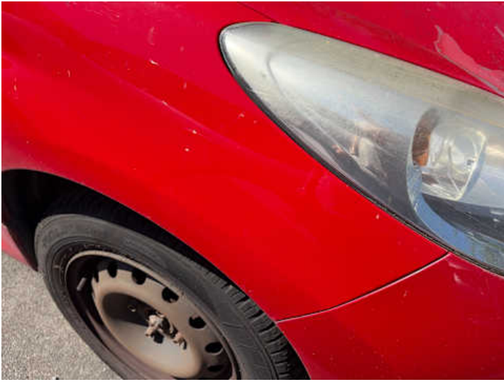
Kotflügel vorne rechts (Lackschaden, Kratzer)
