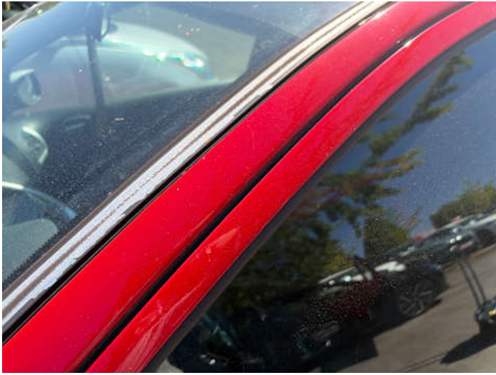
Dach (Lackschaden, Kratzer)
