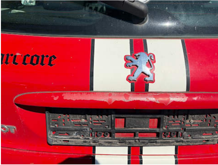
Heckklappe (Lackschaden, Kratzer)
