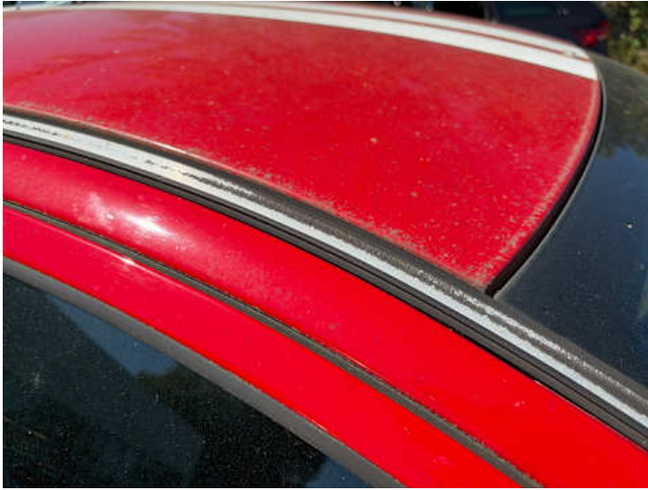
Dach (Lackschaden, Kratzer)
