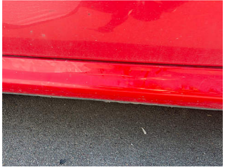
Schweller links (Lackschaden, Kratzer)
