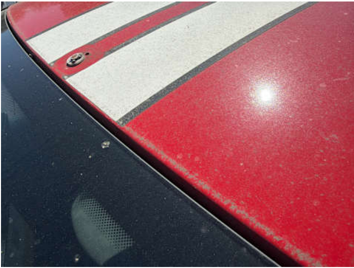
Dach (Lackschaden, Kratzer)
