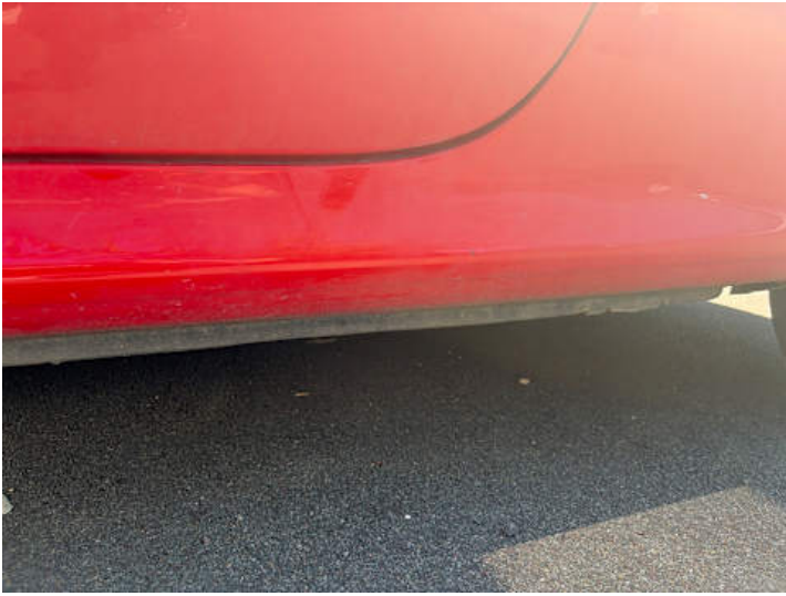
Schweller links (Lackschaden, Kratzer)
