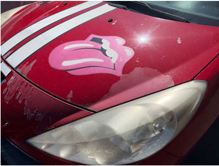
Motorhaube (Lackschaden, Kratzer)
