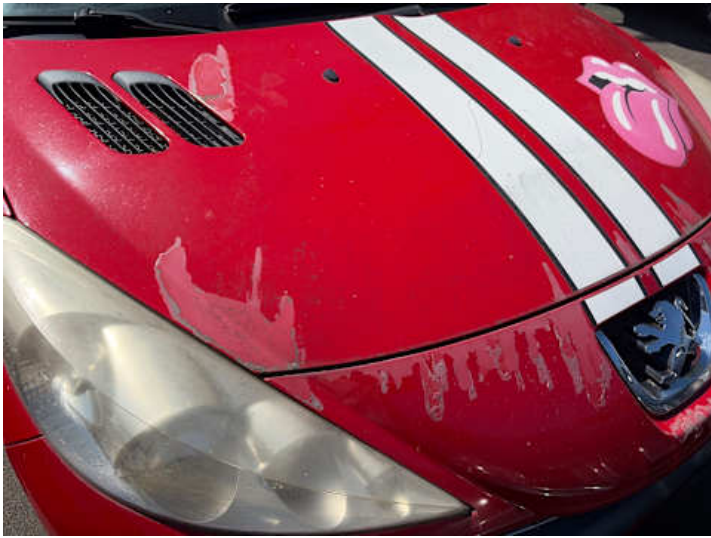
Motorhaube (Lackschaden, Kratzer)
