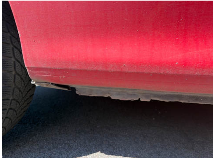
Schweller rechts (Lackschaden, Kratzer)
