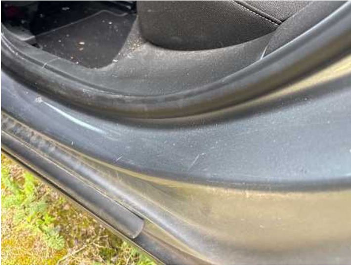
Schweller links (Kratzer)
