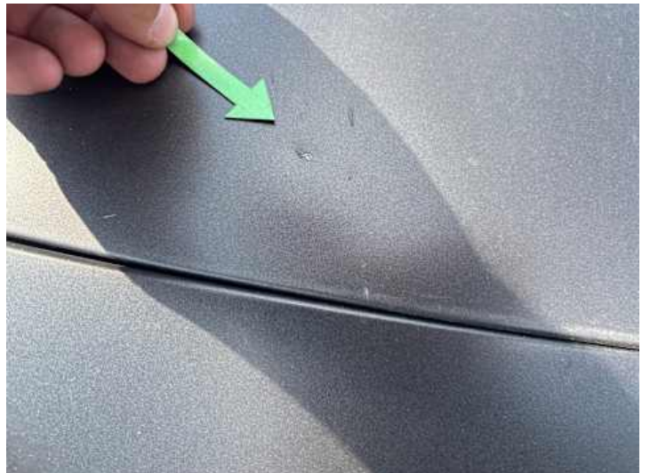
Motorhaube (Verformung, Delle)
