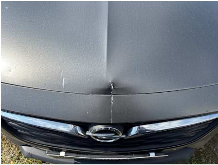
Motorhaube (Verformung, Delle)
