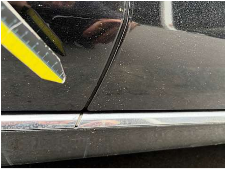
Beifahrertür (Lackschaden, Kratzer)
