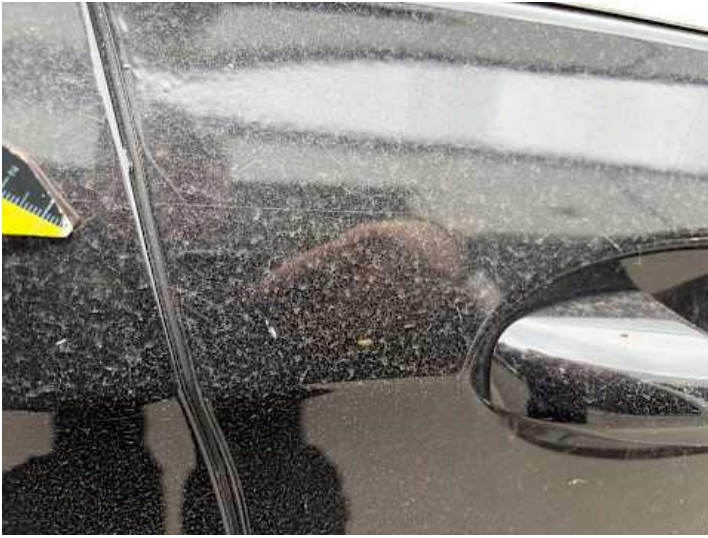
Beifahrertür (Lackschaden, Kratzer)
