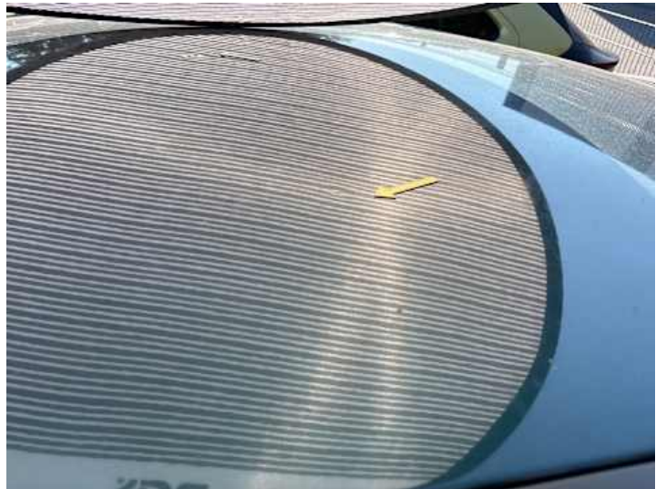
Dach (Kratzer, Delle)
