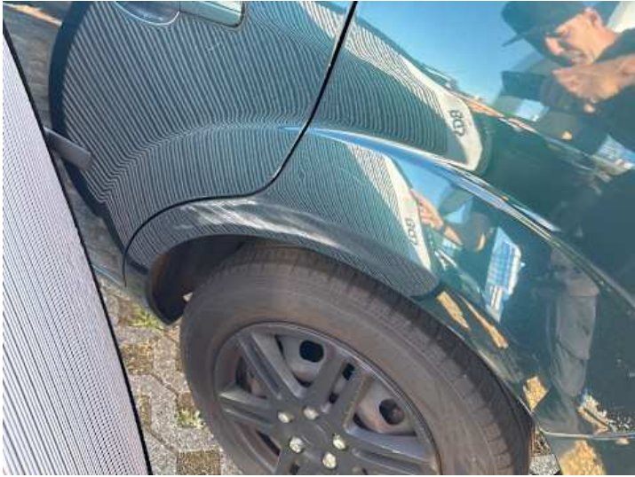
Seitenteil hinten links (Kratzer, Delle, Lackschaden)
