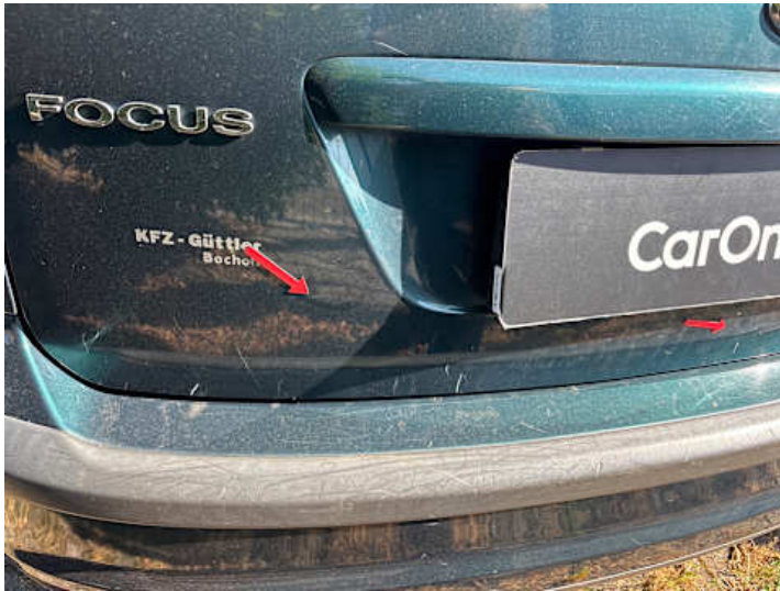
Heckklappe (Kratzer, Delle, Lackschaden)
