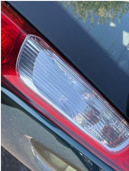
Rücklicht (rechts) (Riss/Bruch)
