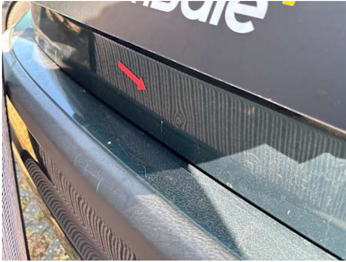
Heckklappe (Kratzer, Delle, Lackschaden)
