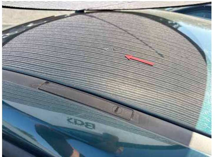
Dach (Kratzer, Delle)
