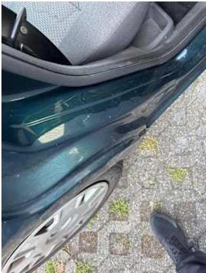
Schweller rechts (Kratzer, Delle)
