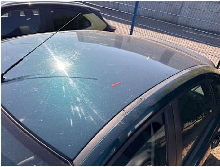
Dach (Kratzer, Delle)
