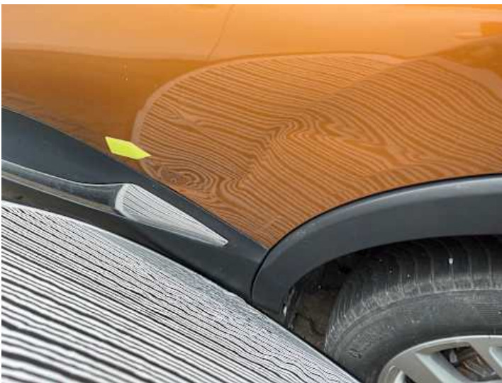
Türe hinten links (Verformung)
