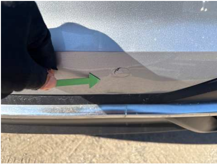
Stoßstange hinten (Verformung)
