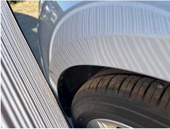
Kotflügel vorne links (Verformung)
