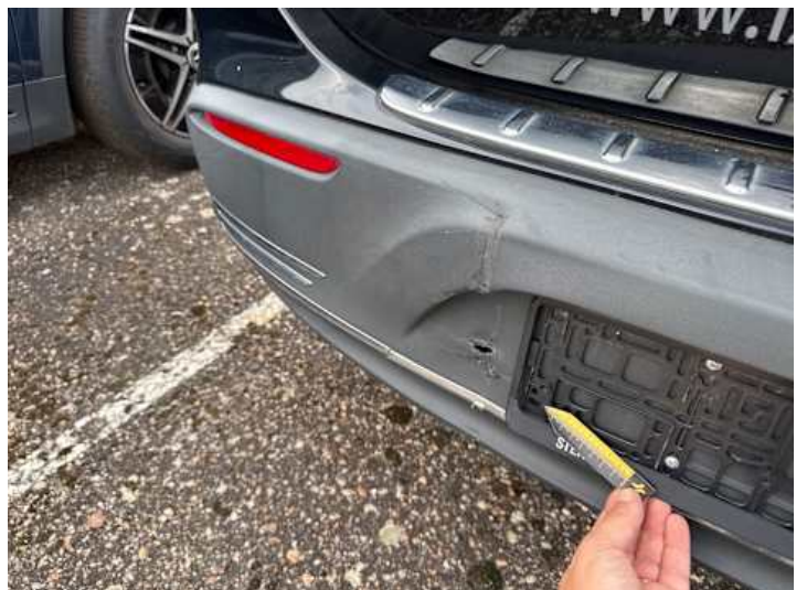
Stoßstange hinten (Kratzer, Riss/Bruch)
