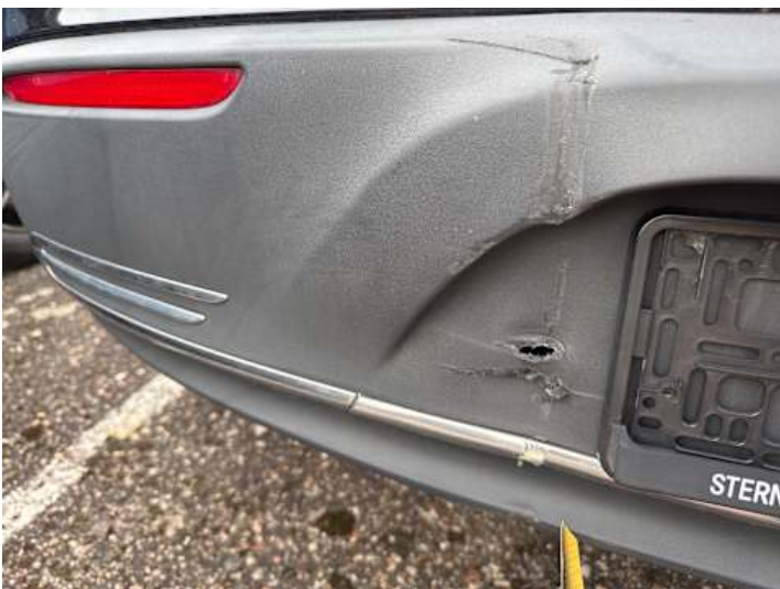
Stoßstange hinten (Kratzer, Riss/Bruch)
