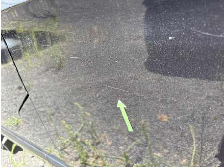
Türe hinten links (Kratzer)
