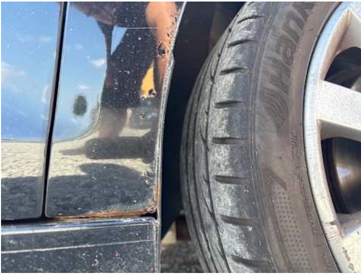
Kotflügel vorne rechts (Rost)
