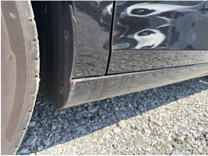
Schweller links (Rost)
