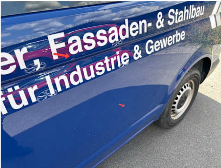
Seitenteil hinten links (Verformung, Kratzer)
