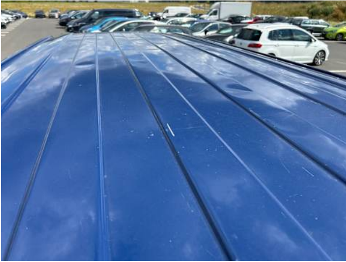
Dach (Verformung, Kratzer)
