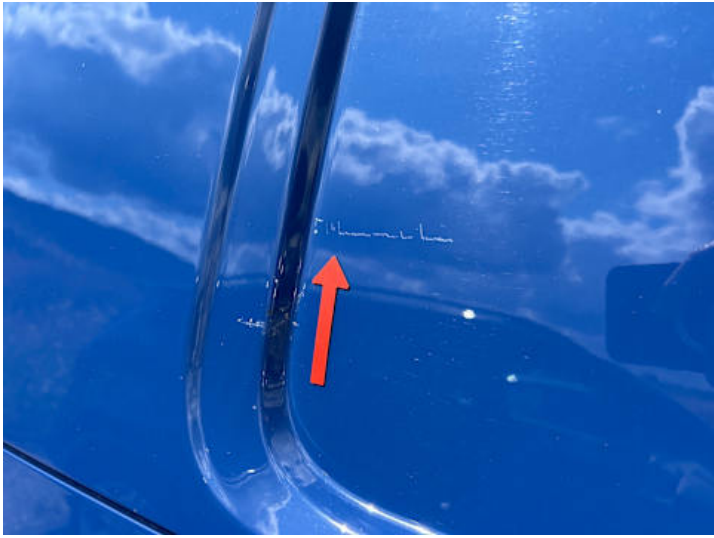
Seitenteil hinten rechts (Verformung, Kratzer)
