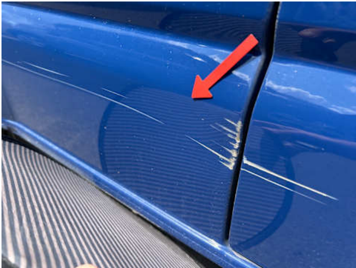
Seitenteil hinten rechts (Kratzer, Verformung)
