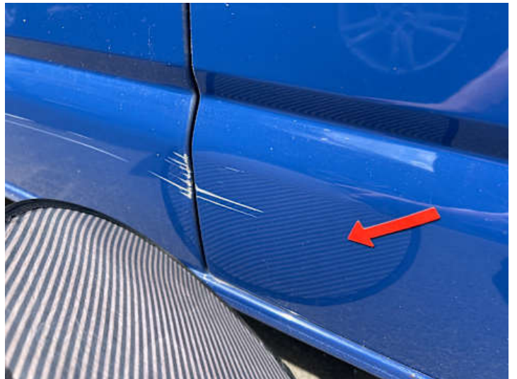
Türe hinten rechts (Kratzer, Verformung)
