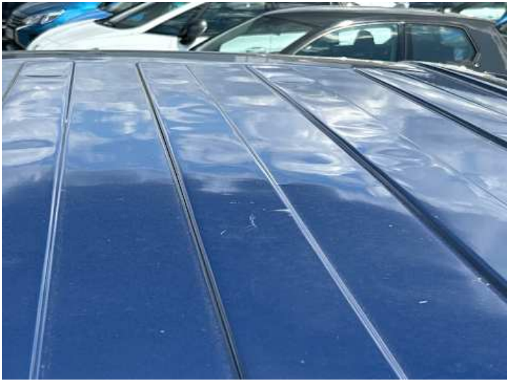
Dach (Verformung, Kratzer)
