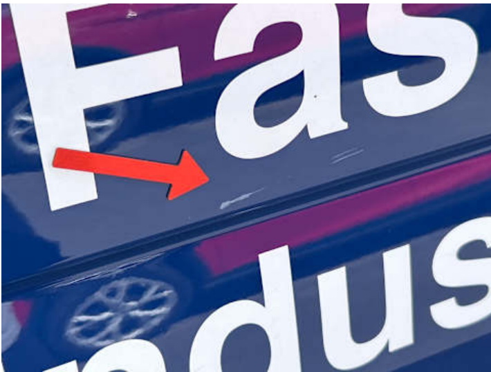
Seitenteil hinten links (Verformung, Kratzer)
