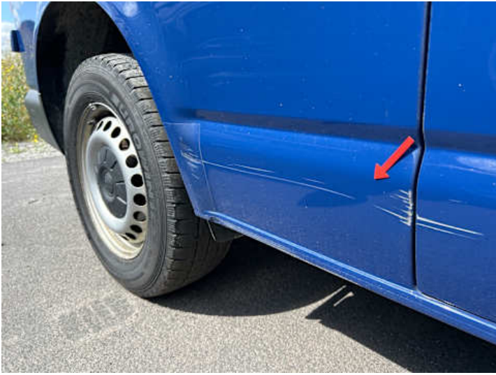
Seitenteil hinten rechts (Kratzer, Verformung)
